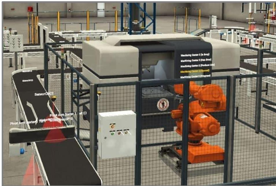
En las siguientes subsecciones se muestran imágenes del diseño final de estos sistemas de interacción con la planta. Para el servicio de inspección o monitoreo, lo valioso es conocer el total de piezas fabricadas y el estado de los procesos, esto para verificar el funcionamiento correcto de la planta. Para el servicio de control, lo indispensable es permitir la activación y desactivación de los diferentes procesos, esto para verificar que responden de manera adecuada.
