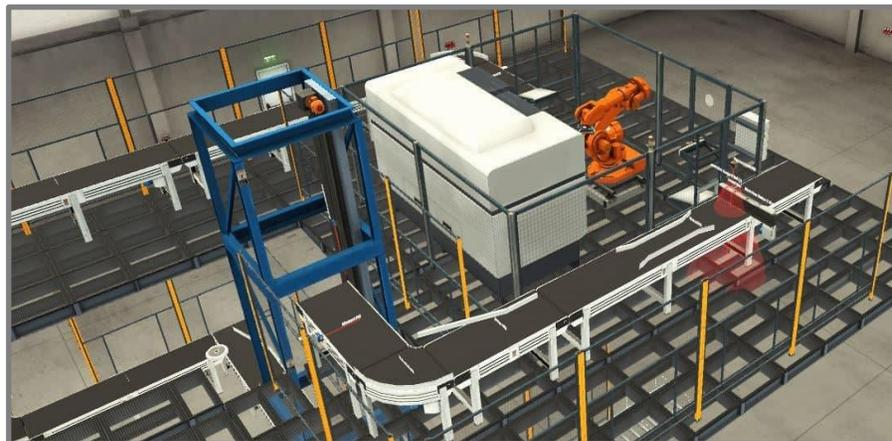
**Cuarto proceso: Embalaje y empaquetado.** El cuarto proceso corresponde a la última etapa de toda la producción de la planta. Para la programación de este proceso únicamente es necesaria la activación de los actuadores, que a su vez acciona los motores. Al final de la línea de transporte principal se encuentra un sensor óptico, que al detectar la presencia de una pieza envía una caja mediante una banda para que ésta sea empaquetada. La figura 17 presenta el diseño de esta sección de la planta.
