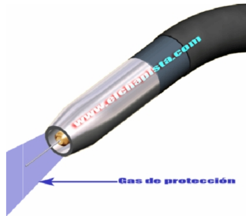
Fig.1.21 Salida del gas y el hilo por la tobera de la pistola
