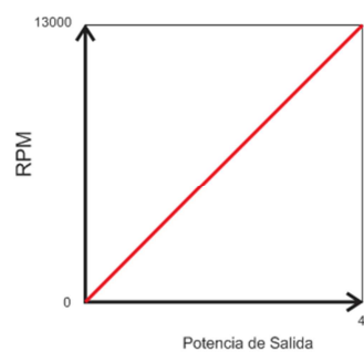
Figura 3. 38. Escalamiento para la potencia de salida del motor Inrunner
