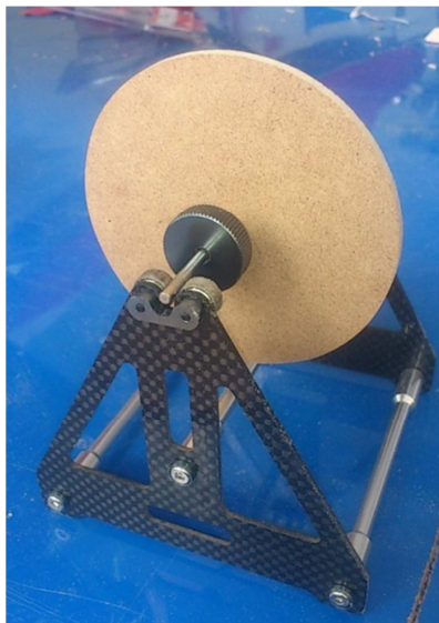
Foto 3.22. Revisión del balance del disco
