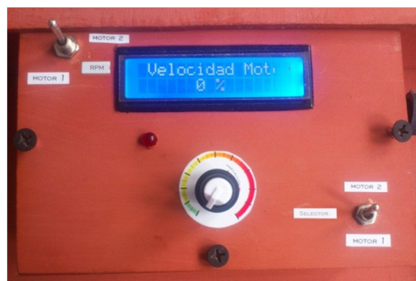
Foto 3.32. Vista general del control de velocidad
