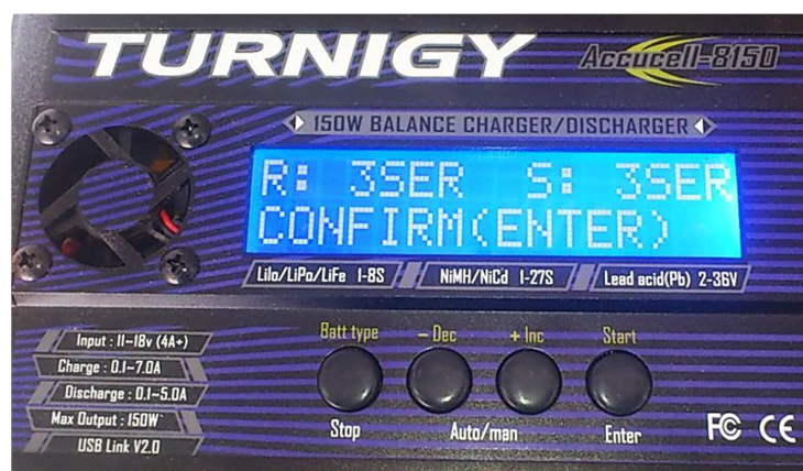
Foto 3.46. Pantalla previa a la carga del pack de baterías.
