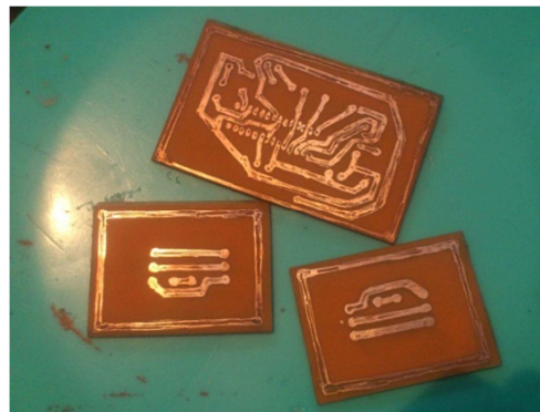
Foto 3.33. Placas después del paso por cloruro férrico.
