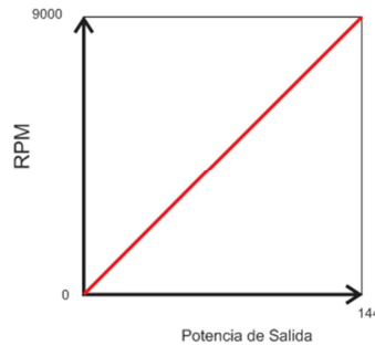
Figura 3. 41. Escalamiento para la potencia de salida del motor Outrunner
