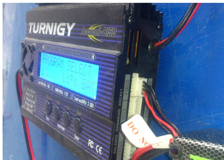
Foto 3.37. Ranuras destinadas para los conectores de las celdas
