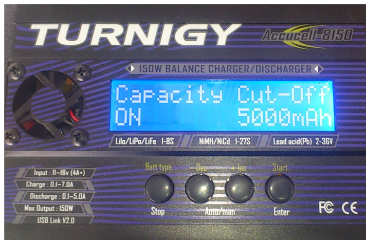
Foto 3.43. Configuración de “Capacity Cut Off” en el display del Accucell-8150
