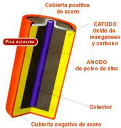
Figura 2. 10. Configuración interna de una batería
