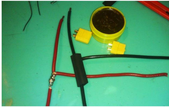
Foto 3.25. Elaboración de la extensión para la medición de corriente
