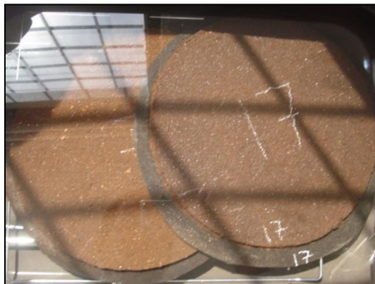
Figura 5.11: Muestras en agua a 25°C por una hora.
