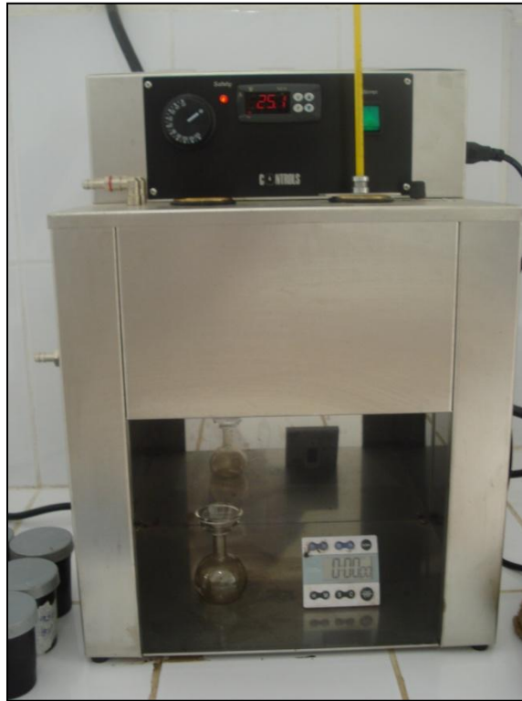
Figura 4.6: Viscosímetro calibrado a 25 ° C.
