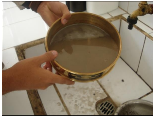
Figura 3.26: Lavado del Material a través del tamiz N° 200
