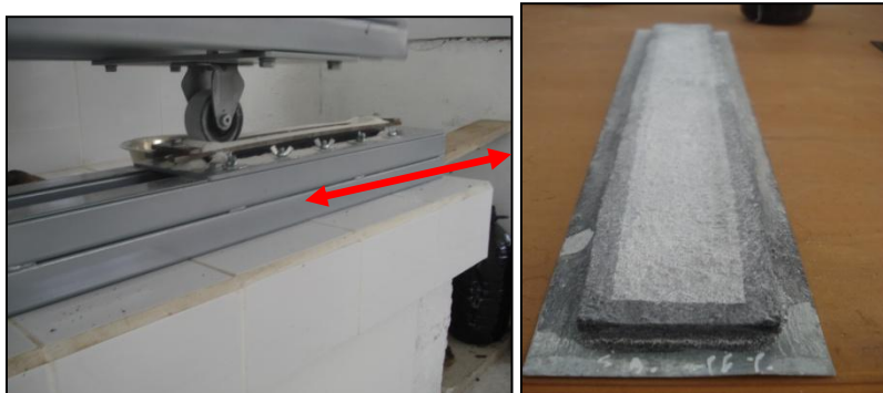
Figura 5.23: 100 ciclos adicionales y limpieza de la arena no adherida.
