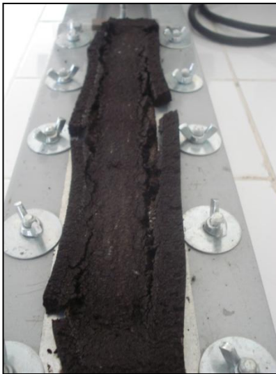
Figura 5.26: Muestra dañada antes de los 1000 ciclos.
