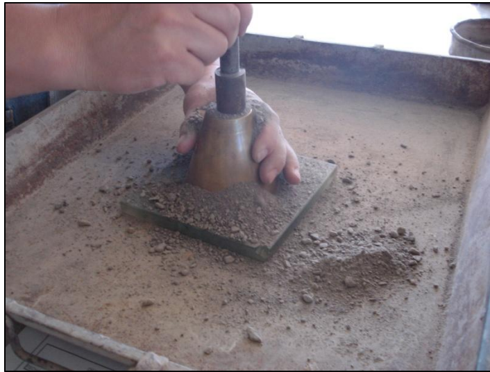
Figura 3.6: Ensayo de humedad, colocación de agregado en el cono.
