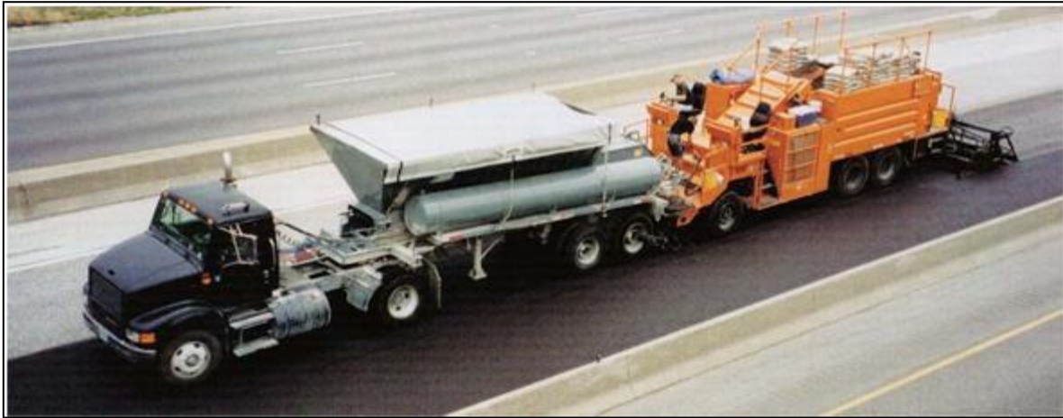
Figura 7.1: Máquina típica de aplicación continua de micro-pavimentos
