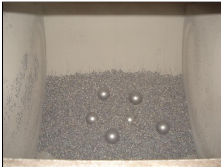
Figura 3.14: Agregado y carga abrasiva.
