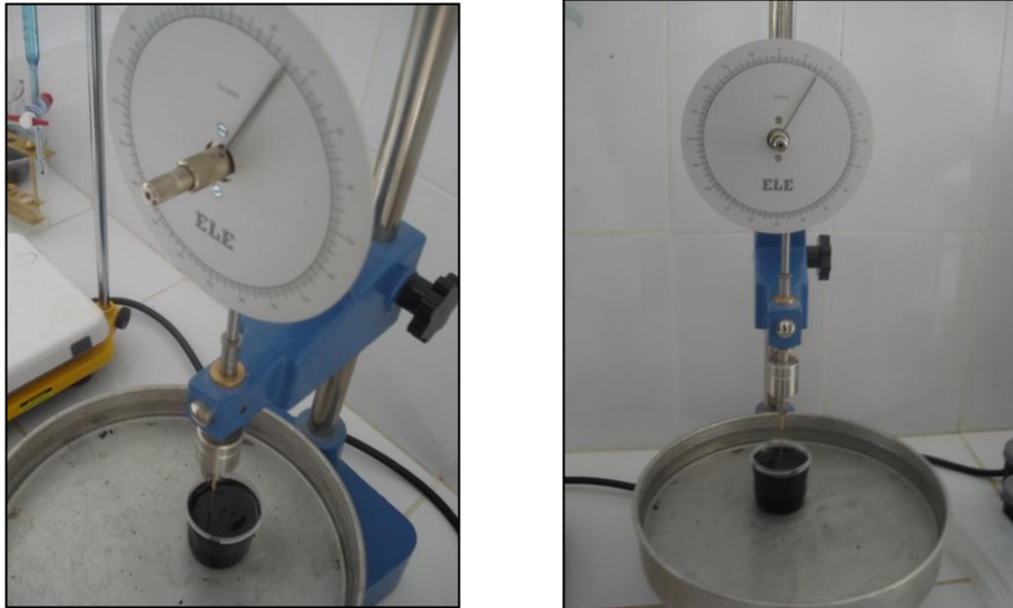
Figura 4.29: Penetración en el asfalto luego de soltar la aguja.
