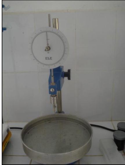
Figura 4.25: Penetrómetro en baño
