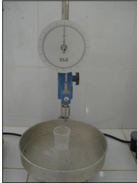
Figura 4.24: Equipo para ensayo de penetración.
