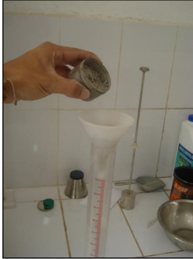
Figura 3.19: Vertido del agregado.
