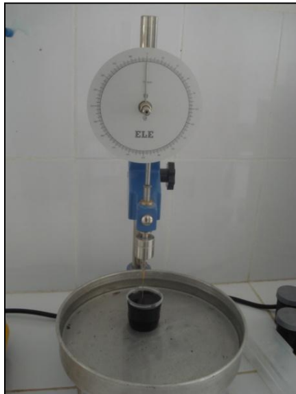
Figura 4.26: Penetrómetro en baño con muestra
