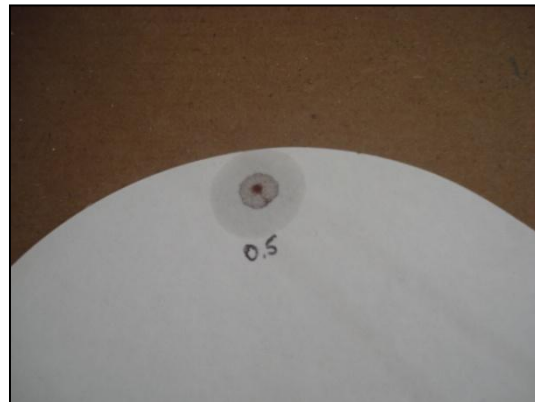
Figura 3.32: Punto inicial del Ensayo de MB.
