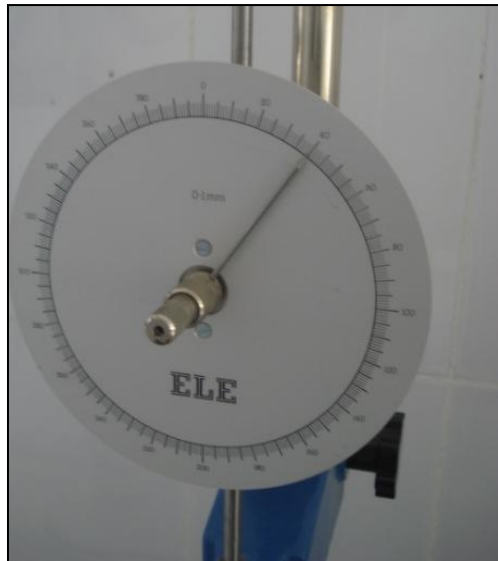
Figura 4.30: Penetración en el asfalto a 250 C y 5 segundos.
