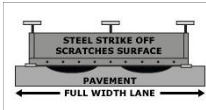
Figura 7.19: Principio de recuperación de ahuellamiento.
