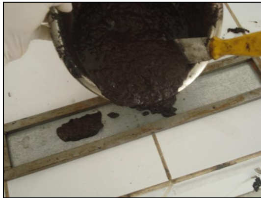
Figura 5.16: Colocación de la muestra en el molde.
