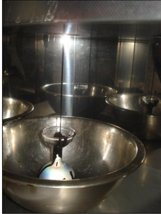
Figura 4.11: Flujo de la emulsión a través del viscosímetro al vaso receptor una vez retirado el corcho.
