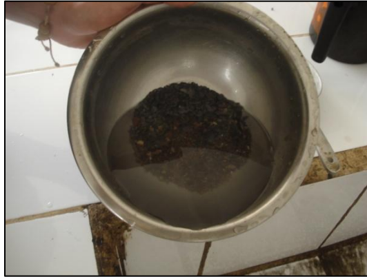
Figura 3.27: Agregado lavado, agua limpia.
