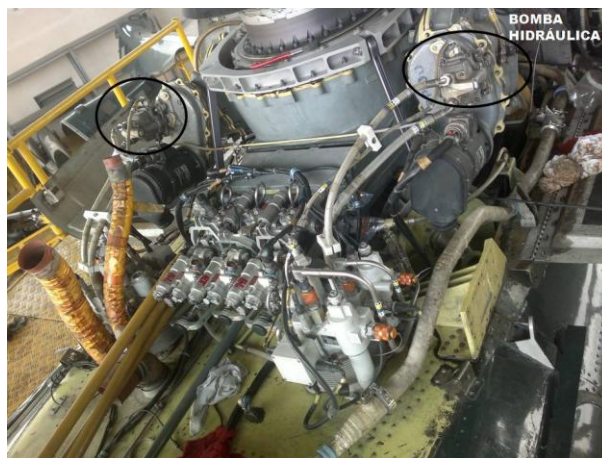
Figura 2.3: Bomba hidráulica Fuente: Helicóptero FAE-605
