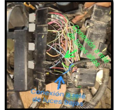
El sistema NMD es un sensor optoelectrónico el cual está alimentado con 12V – DC y está conectado a los relés de luces altas y bajas del vehículo, cuya función es encender las luces de manera automática al detectar un poco cantidad de luz
