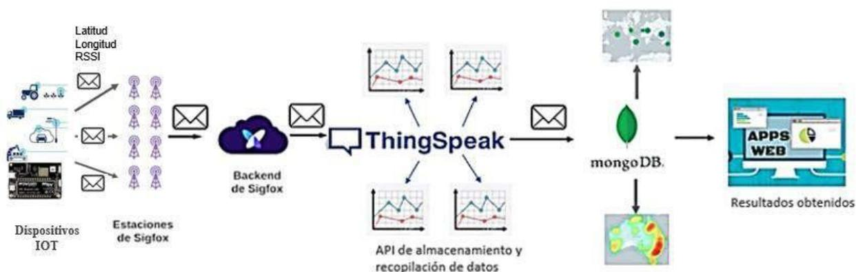
Nota. La figura se observa el diagrama de bloques que representa las etapas por las que pasa los mensajes entre la conexión del dispositivo hasta llegar a la aplicación web.
