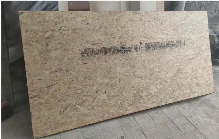
En este caso se ha utilizado un panel de 9.5 mm de espesor. Las muestras para cada ensayo se realizaron en un aserradero con la maquinaria necesaria para realizar los cortes.
