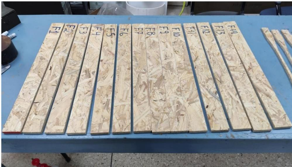
Por otro lado, se obtuvo las dimensiones tanto de largo, ancho y espesor de cada una de las muestras con ayuda de un calibrador electrónico Fowler, dichas dimensiones se presentan en la tabla 5.
