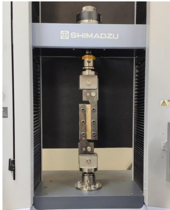
Para continuar con el ensayo se procede a configurar la máquina para que aplique una fuerza desde el accesorio superior a una velocidad constante de 1 mm/min para que la muestra falle en un rango ente 3 y 10 min como expone la norma.
