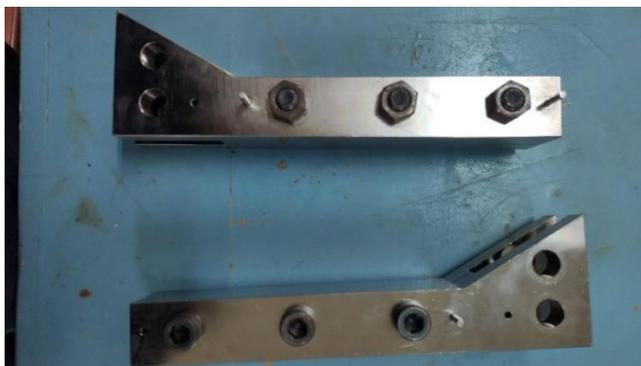
Para proceder con el ensayo a corte se coloca las muestras en las mordazas sujetándolas de cada extremo.
