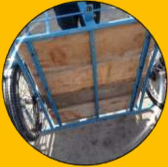
Para la construcción de la base del triciclo se procedió con las medidas y perfiles L (ángulos) simulados en el Software de SolidWorks teniendo un tamaño de 1240mmx1000m (ancho x largo)
