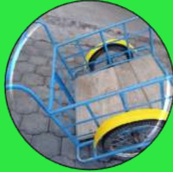
Para las paredes de la canastilla se utilizó una tubería redonda de 1 pulgada por 3 mm de espesor además se utilizaran platinas de acero de  $\frac{3}{4}$  de pulgada la cual evitará que si se lleva carga pequeña esta se salga de la canastilla
