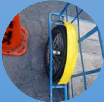
Se construyó unos guardabarros para las llantas delanteras para evitar que cuando llueva el agua salpique hacia el conductor
