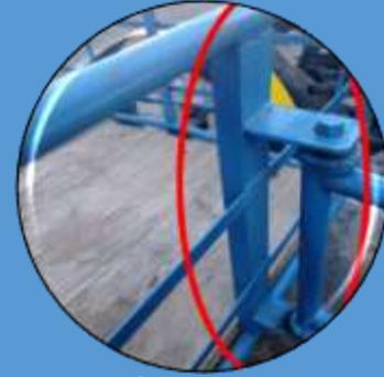
se ocupó una viga U de 50mmx25mmx2mm (ancho, profundidad, espesor) la misma que sirve como soporte para la unión de la canastilla del triciclo con el cuadro de la bicicleta mediante un tornillo de transmisión
