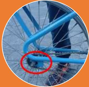
Adaptación de platinas para la rueda debido a que llevara un motor eléctrico.
