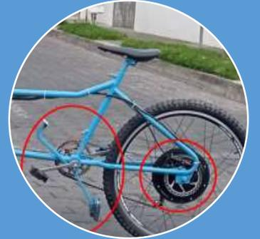
Se construyo dos tipos de freno uno de sistema mecánico accionado mediante el pie y uno hidráulico el mismo que fue implementado como un sistema de seguridad adicional
