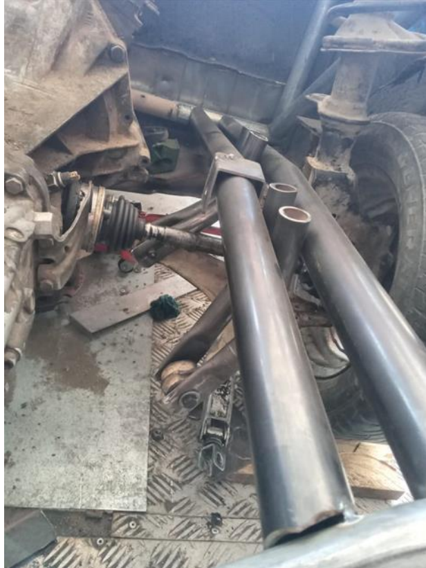
Construcción de las bases del motor
