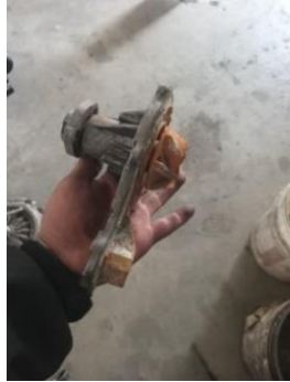
Bomba de agua
