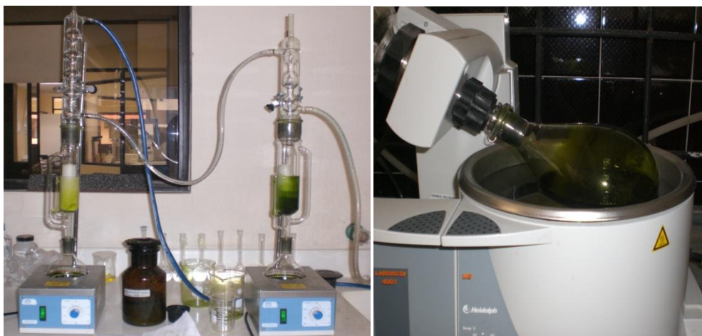
Figura 2.51 Extracción de alcaloides mediante el método soxhlet y su concentración en el rotavapor
