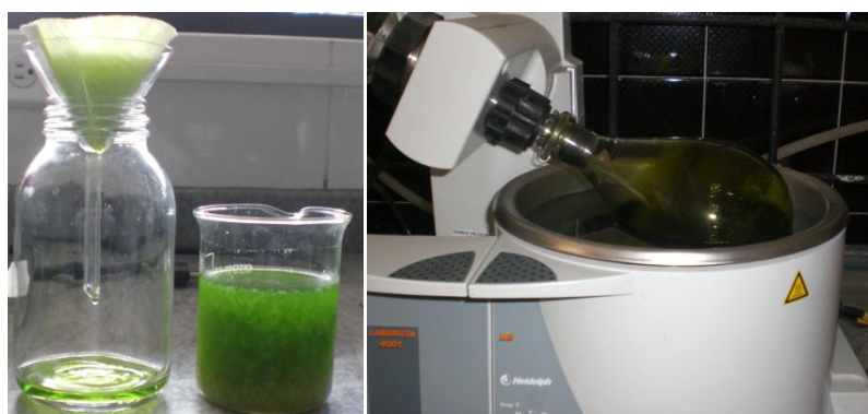
Figura 2.5.3 Filtrado y concentración en el rotavapor del extracto de las larvas del gusano de seda
