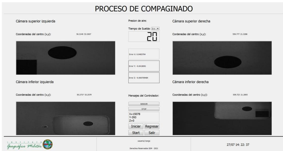
Como se observa en la Figura 111 el sistema ha alcanzado su alineación, en el apartado de errores ya se muestra un error de 0.0483 mm en el X, -0.041 mm en el eje Y, y -0.0007° en el eje Z. Como se observa el contador ya paso a 20, eso quiere que van 20 láminas compaginadas desde que se inicializó el sistema por primera vez.
