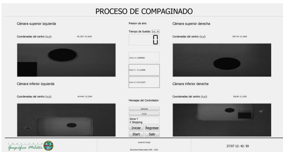
**Nota:** Los puntos se ven desfasados en imagen, pero es debido a la posición de las cámaras, para ello se midió cada punto respecto a un punto de referencia sobre la plancha superior de la máquina.
