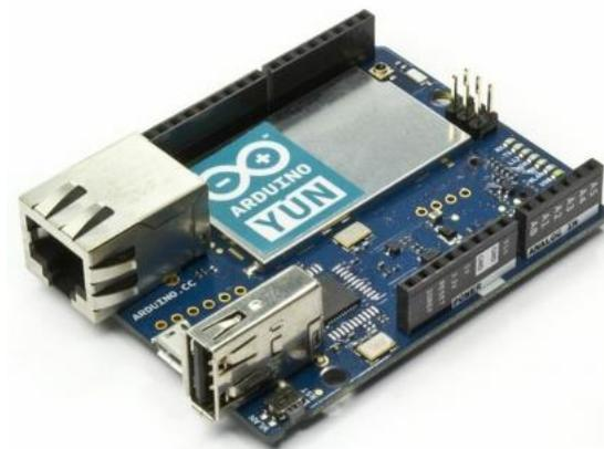
En la figura 2.24 se muestra un Arduino YUN, una tarjeta con capacidad de conectarse a través de un puerto RJ45 y con funcionalidad IoT, útil para ciertas aplicaciones donde se requiera un nivel de automatización alto, o un continuo flujo de datos. Incluso, estas tarjetas son usadas para aplicaciones de domótica, gracias a la compatibilidad de las mismas con asistentes virtuales, con el uso de las librerías adecuadas.
