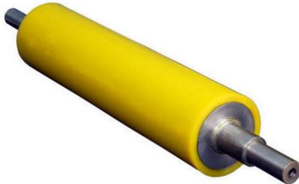
Este tipo de rodillos tienen un recubrimiento flexible, y rodamientos para permitir su libre rotación sin que esto afecte al apoyo de los mismos. Se utiliza un mecanismo similar en los rodillos transductores, considerando que estos tienen un conjunto de celdas de carga, en una configuración de puente de Wheatstone.
