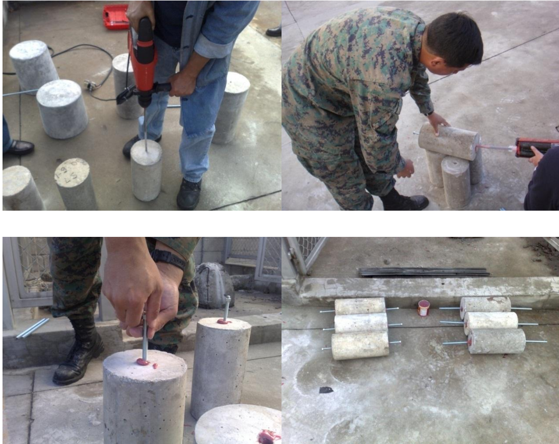
Figura 4.5 Elaboración de Probetas para Sistemas de Anclaje Postinstalados con Enclavamiento Químico.
