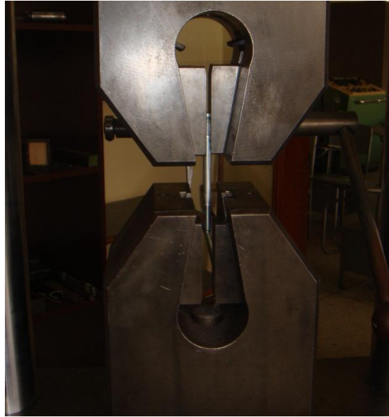
Figura 4.10 Colocación de probetas de acero en la máquina de ensayo.
