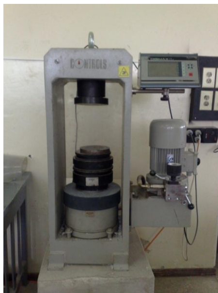
Figura 4.6 Máquina de Ensayo de Compresión
