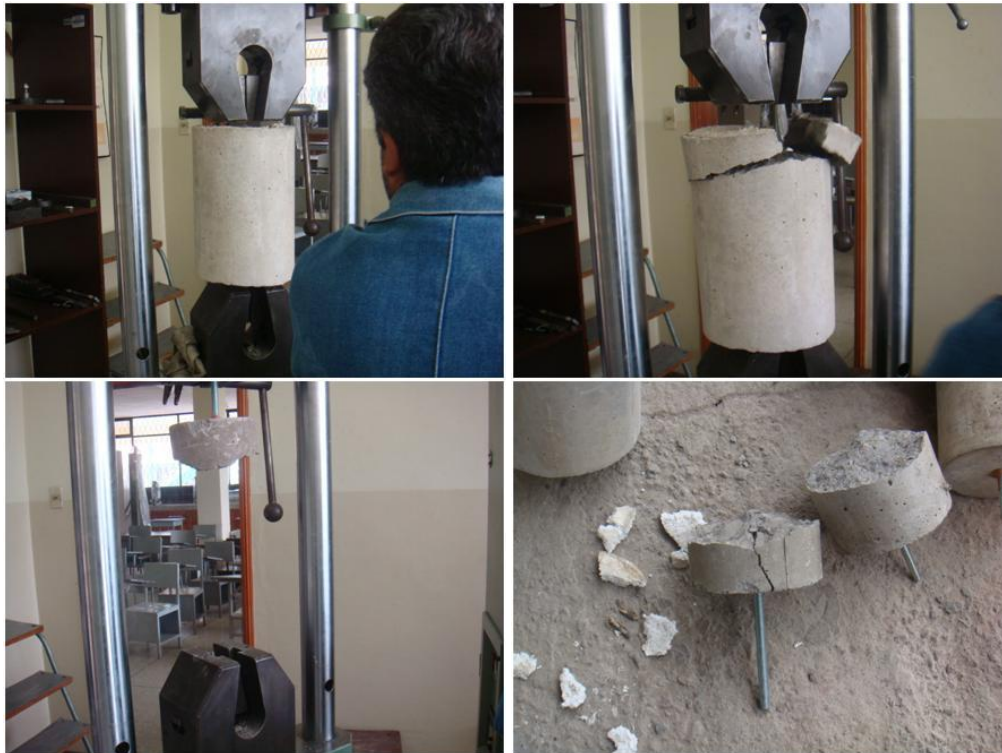
Figura 4.13 Ensayo de sistemas de anclaje a tracción
