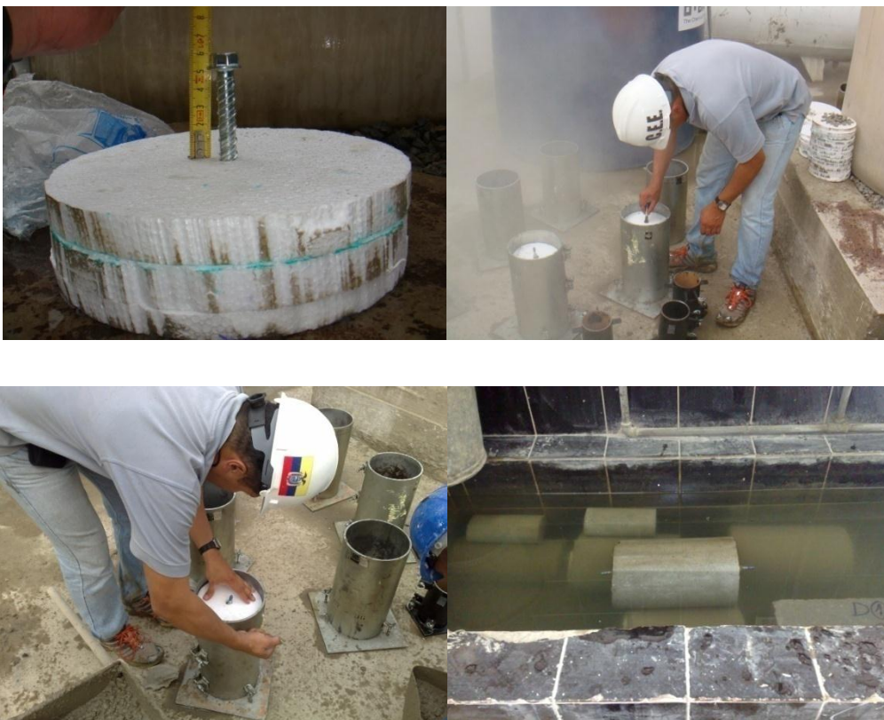
Figura 4.3 Elaboración de Probetas para Sistemas Preinstalados.
