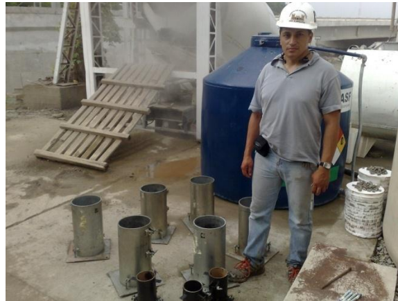
Figura 4.7 Elaboración de Probetas de Concreto para el Ensayo de Compresión.
