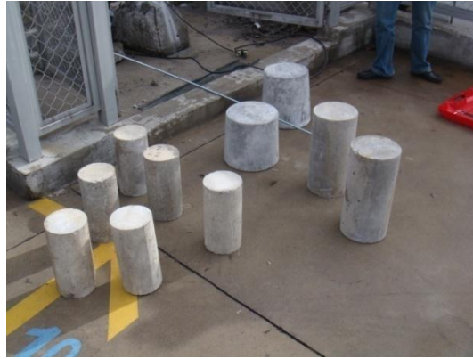
Figura 4.1 Tres tipos de cilindros elaborados.
