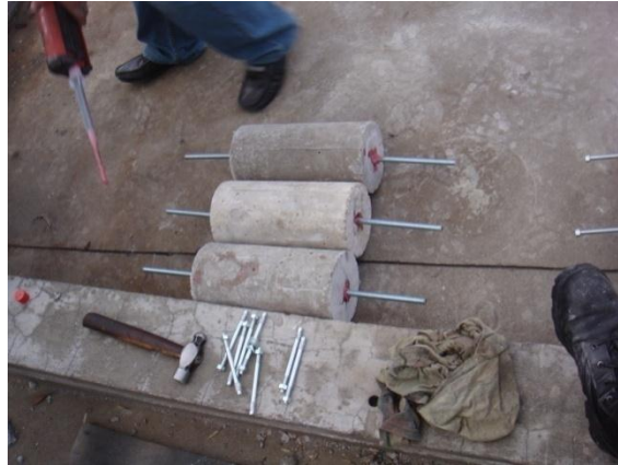
Figura 4.2 Elaboración de Probetas.
