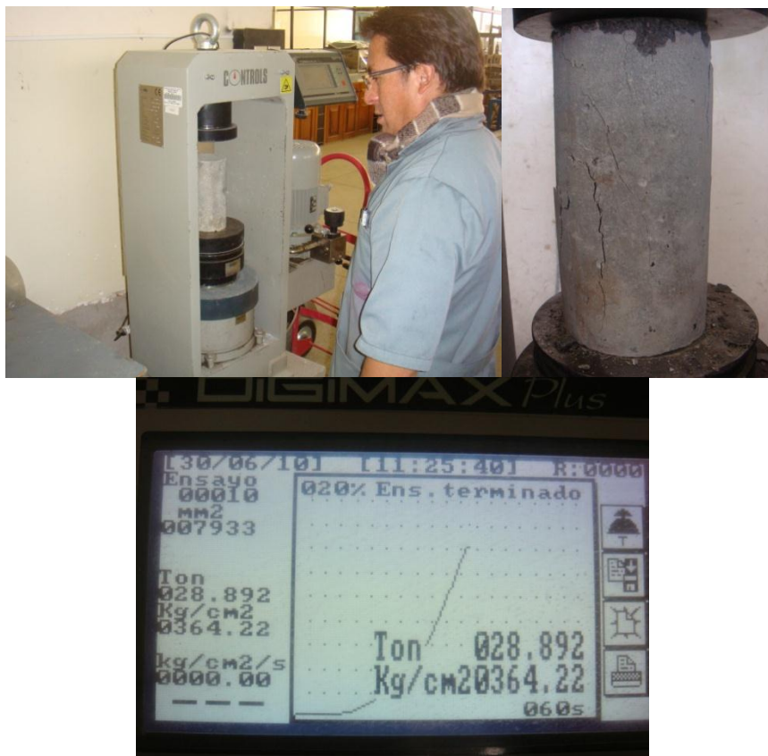
Figura 4.8 Ensayo de Compresión realizado a los 28 días.
