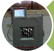
Preparación del extracto en microondas (Anton Para Multiwave PRO Microwave Reaction System)
