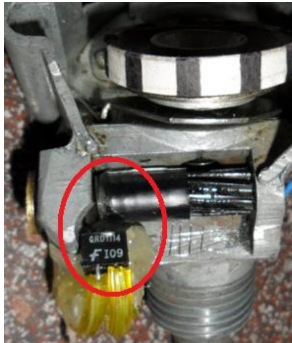
Figura 4.15. Ubicación del sensor óptico del odómetro
