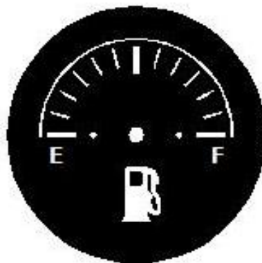
Figura 5.7. Diseño de la interfaz del medidor de combustible
