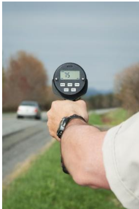
Figura 2.19. Medición de velocidad usando radar.
