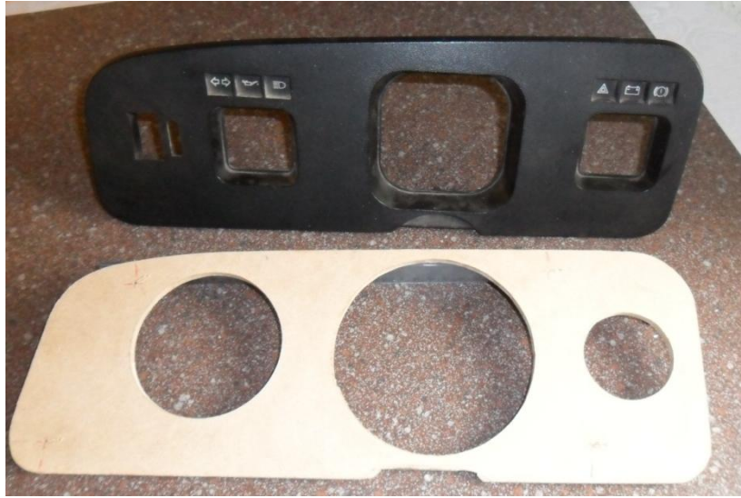
Figura 6.10. Nuevo panel de madera
