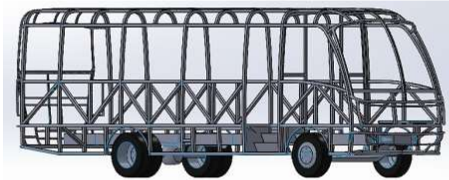
Estructura de un minibús escolar
