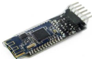
*Nota.* Como se ilustra en la imagen este módulo Bluetooth es uno de los dos métodos principales para ejecutar el control de los sistemas del vehículo para el bloqueo. Tomado de Naylamp Mechatronics, 2021.
