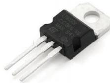
*Nota.* En la imagen se tiene un integrado LM7805, su característica principal es un regulador de voltaje DC/DC con salida a 5V. Tomado de Diseño e implementación de un sistema para vigilancia y bloqueo remoto de vehículo mediante un smartphone y Tablet con acceso a internet, por Morales, Henry, 2016.
