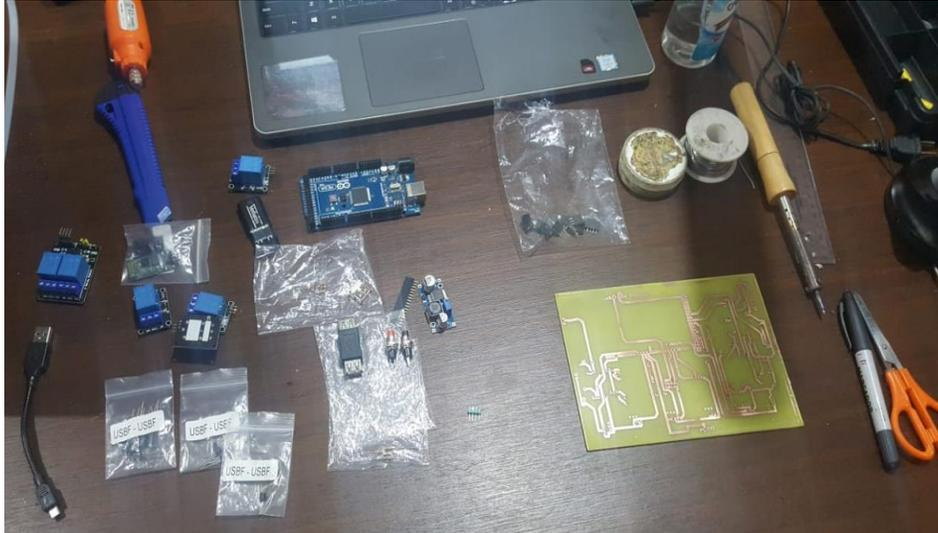
*Nota.* En la imagen se ilustra todos los componentes que serán incorporados al módulo de seguridad, sensores actuadores, componentes electrónicos.
