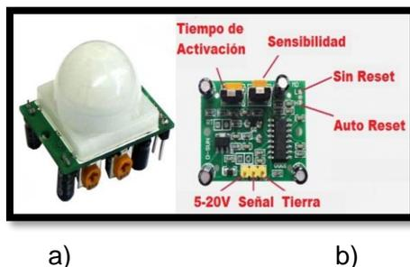
*Nota.* Detalles externos y circuito interno de un sensor de movimiento. a) Vista externa del sensor del sensor de movimiento HC-SR501 b) Circuito internos y pines de conexión del sensor del sensor de movimiento HC-SR501. Tomado de, Diario Electrónico Hoy, por García Vicente, 2017.
