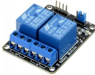
*Nota.* En la gráfica se denota el módulo relé el cual estará en la obligación de activar y desactivar el corte a los sistemas, esto se activará cuando llegue información del Arduino.
