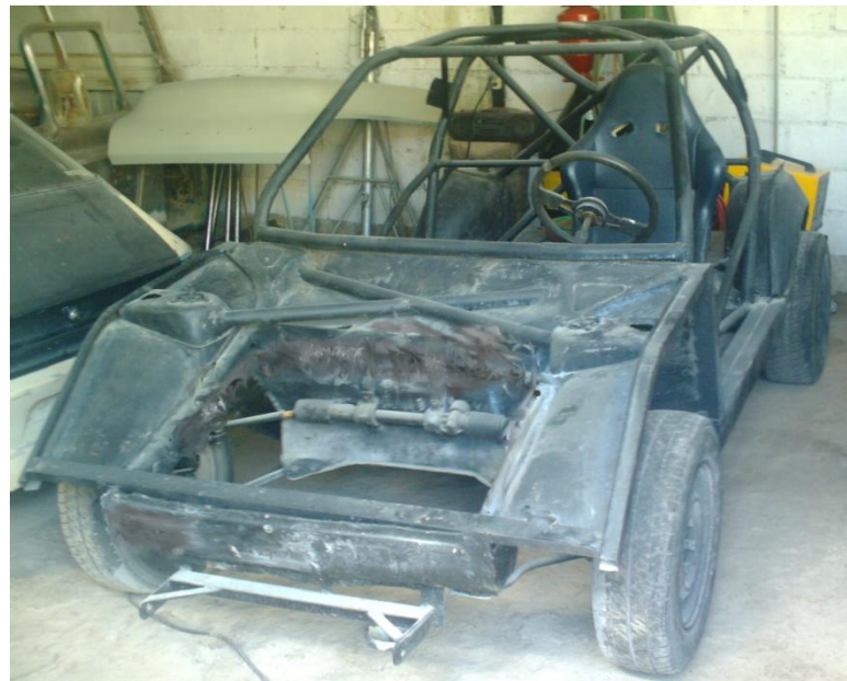
Fig. 92. Prototipo con anticorrosivo.
