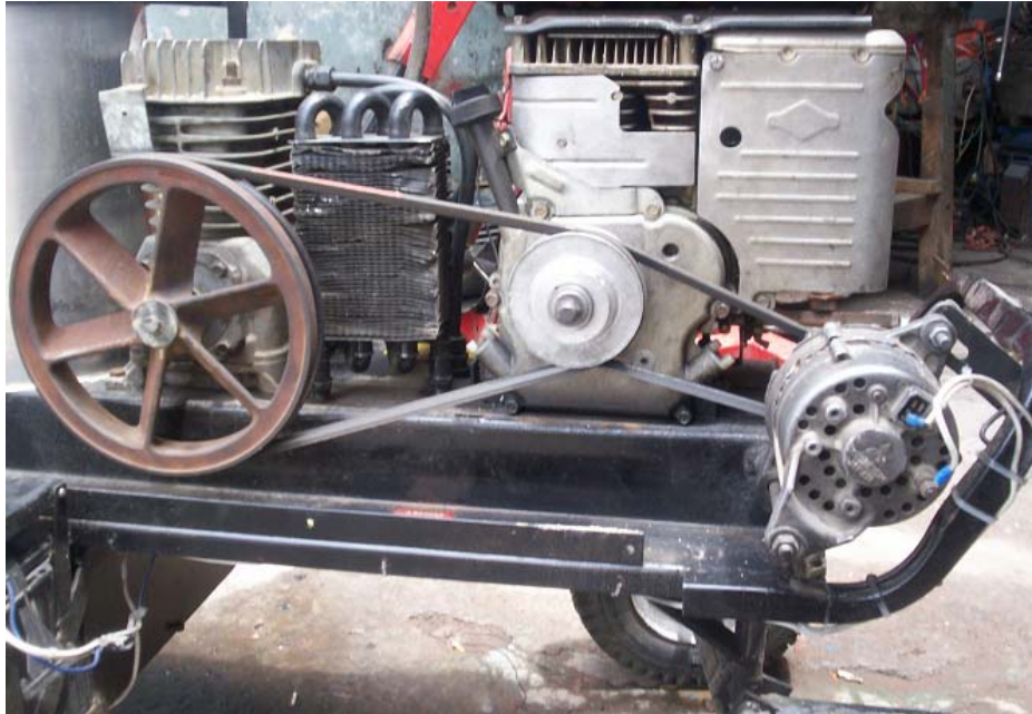
Figura 2.35 Acople del alternador al motor de la máquina
