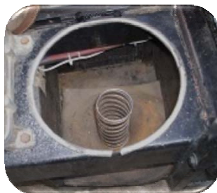
Figura 2.44 Resorte para detección de nivel
