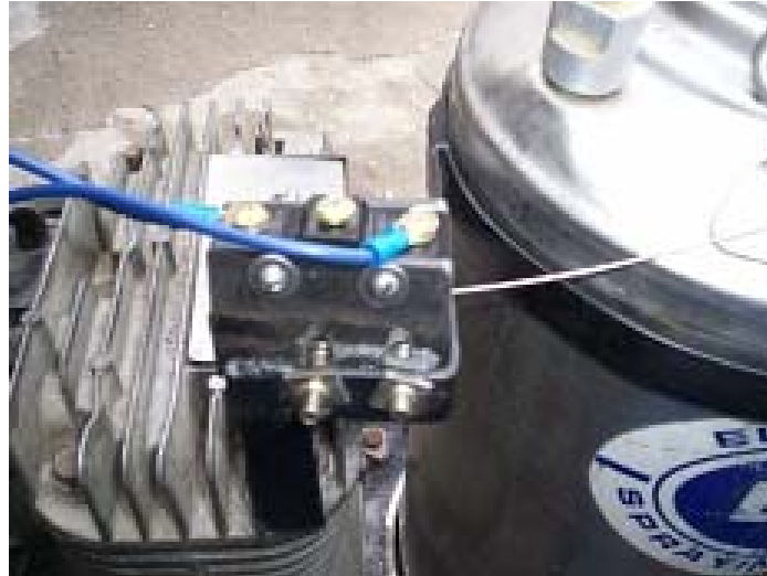
Figura 2.45 Microswicht indicador de nivel
