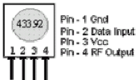
Figura 1.40 Disposición y función de cada pin del TWS-434
