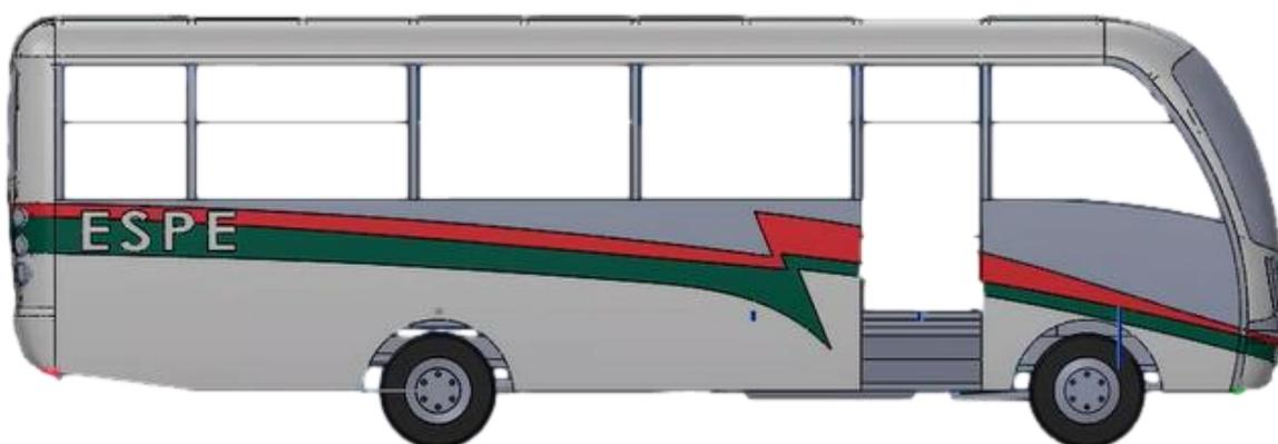
*Nota. En la figura se muestra el panel lateral derecho perteneciente al bus Volkswagen 9-150, también se visualiza detalles de la carrocería como son emblemas y colores característicos de los buses de la Universidad de las Fuerzas Armadas, este panel es modelado en software CAD (SolidWorks).*
