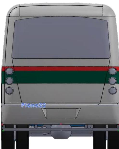
*Nota.* En la figura se muestra el panel posterior perteneciente al bus Volkswagen 9-150, también se visualiza detalles de la carrocería como son emblemas y colores característicos de los buses de la Universidad de las Fuerzas Armadas, este panel es modelado en software CAD (SolidWorks).
