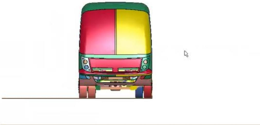
*Nota.* En la figura se muestra la plataforma de basculamiento, la cual deberá rotar levantando simultáneamente los ejes del vehículo, sus características y especificaciones se detallan en el Reglamento número 66.
