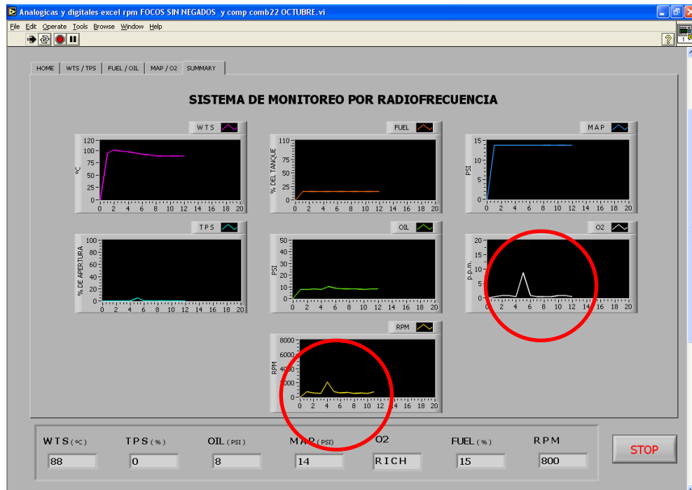
Figura 3.15 Pantalla Inicial Comportamiento del vehículo desconectado el sensor MAP (Ralenti)
