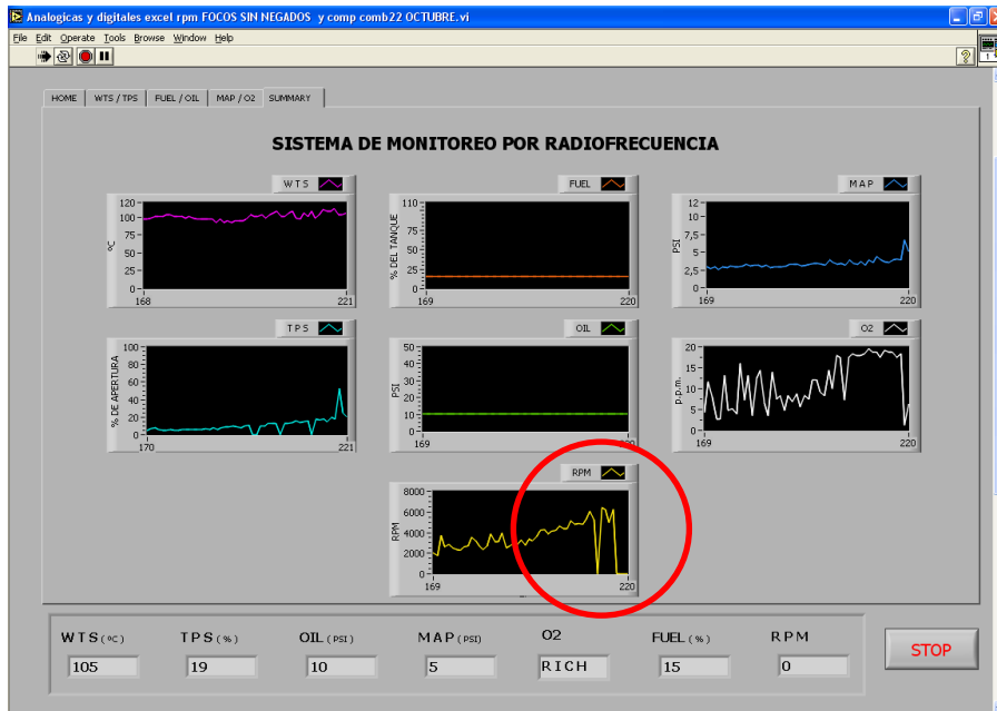
Figura 3.6 Pantalla inicial funcionamiento normal del vehículo (6500 RPM Corte de Inyección)
