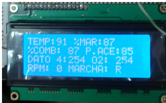
Figura 2.19 HMI con LCD instalado en el vehículo
