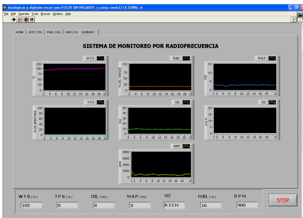
Figura 3.20 Pantalla Inicial Comportamiento del vehículo desconectado el sensor Oxígeno (Ralentí)
