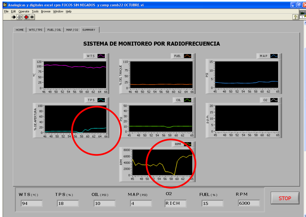
Figura 3.23 Pantalla Inicial Comportamiento del vehículo desconectado el sensor Oxígeno (6300 RPM)
