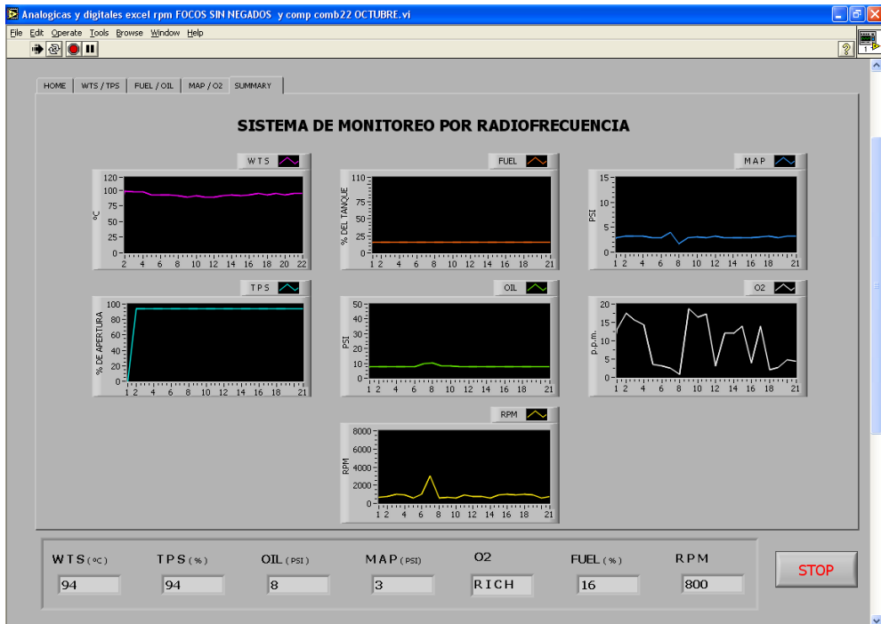
Figura 3.12 Pantalla Inicial Comportamiento del vehículo desconectado el sensor TPS (Ralenti)
