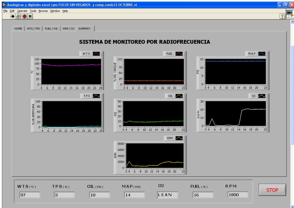
Figura 3.16 Pantalla Inicial Comportamiento del vehículo desconectado el sensor MAP (1800 RPM)
