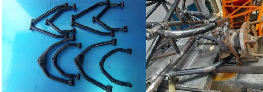
e) Una vez con las piezas ya terminadas se procede a unir estas mediante el proceso de solda conocido como MIG, se soldarán las piezas, así como los terminales además de un par de juntas en el chasis, como se puede observar en la figura 30 se realizó el proceso de solda MIG reforzando los puntos donde fueron sujetos nuestros triángulos de suspensión.
