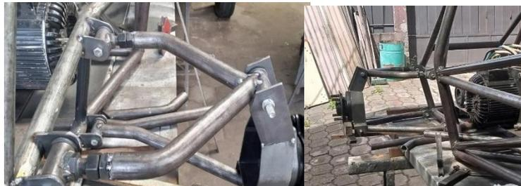
o) Se montarán los amortiguadores de gas con muelle, estos estarán sujetos por un extremo la punta del triángulo de suspensión superior por medio de un buje y por otro extremo se procederá a sujetar al componente denominado balancín de suspensión el cual este estará
