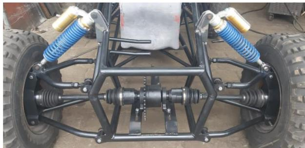
q) Una vez realizado todos los pasos anteriormente mencionados se dará por finalizado el proceso de implementación del sistema suspensión para el prototipo de vehículo de competición fórmula SAE eléctrico, el resultado se muestra en la figura 51.
