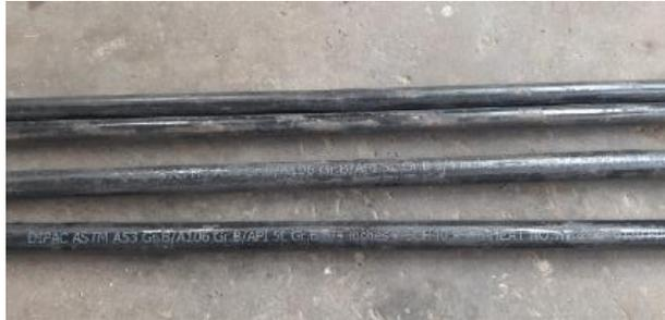
c) Cortamos el tubo en sus medidas necesarias para luego proceder a doblarlos y darles la forma necesaria, para así poder adaptarlo a nuestro prototipo, como se puede ver en la figura 38 una vez cortados los tubos, se le fue dando forma a estos con una dobladora.
