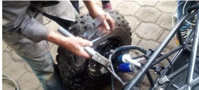
f) Ya con el sistema de dirección instalado solo queda modificar los ángulos de camber, convergencia y caster. En estos casos los ángulos deben estar en el sistema de dirección es de 4° negativos en camber, 3° en convergencia y 3° en caster.
