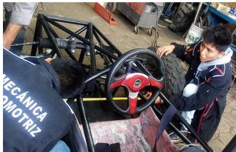
b) Con la referencia que se tiene de las manzanas de las ruedas delanteras podemos posicionar la cremallera, fabricando así la sujeción de este para esto se necesita cortar un pedazo de tubo y darle una forma arqueada soldando a los costados del chasis con la finalidad de que el conductor se sienta conforme al momento de conducir, como se muestra en la figura 53 en la cual se fija la rótula a la pieza antes mencionada.
