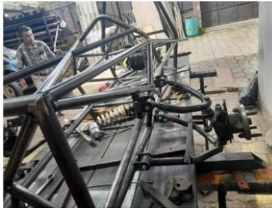
g) Una vez colocado los triángulos de suspensión se ubicarán nuestros amortiguadores de gas como muelle es sus respectivos lugares, los amortiguadores de la parte delantera se colocarán en medio de los triángulos de suspensión cumpliendo así con el efecto de push-rod para obtener así una estabilidad, como se observa en la figura 42 se posiciona primero el amortiguador para proceder con su colocación.
