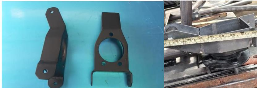
l) Para poder seguir con la instalación del sistema de suspensión posterior se debe construir un sujetador tipo como un balancín de suspensión, esta estará hecha en una lámina de acero de 0.70  $\mu\text{m}$  de espesor y se la realizará con el proceso denominado como Mecanizado con arranque de viruta, con procesos de fresado y torneado, proceso que se muestra en la figura 47.
