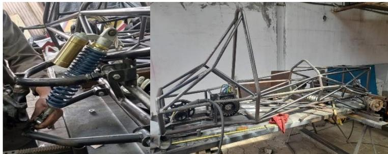
h) Los amortiguadores delanteros estarán sujetos por un extremo al chasis y el otro extremo estará en la punta de nuestro triángulo de suspensión inferior sujeta de igual manera con pernos y bujes, tal como se observa en la figura 43.
