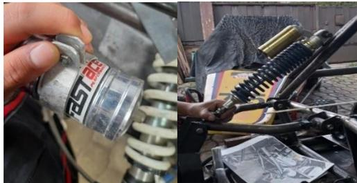
p) El amortiguador posterior se colocará en una posición en la cual esta cumpla con el funcionamiento de Push-Rod para tener un amortiguamiento más eficiente en la parte posterior, al finalizar este paso, el sistema quedará colocado como se puede apreciar en la figura 50.
