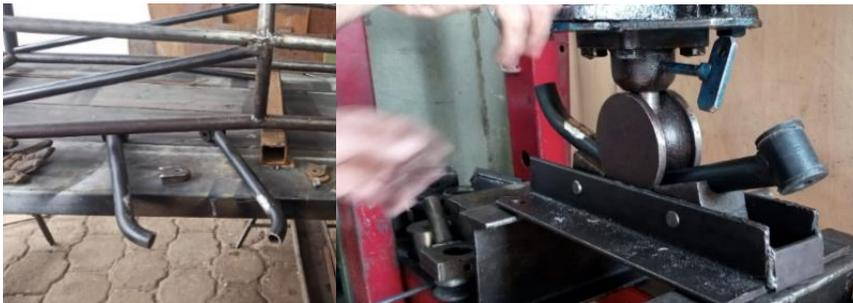
d) Utilizaremos también juntas por unos de sus extremos están se utilizarán para unir nuestro componente al chasis, en el otro extremo utilizaremos terminales y así poder unirla a nuestra manzana de ruedas, como se observa en la figura 39 los triángulos de suspensión ya están terminadas.
