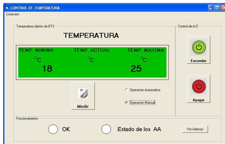
Figura 6.14: Pantalla de Control (Operación Manual)
