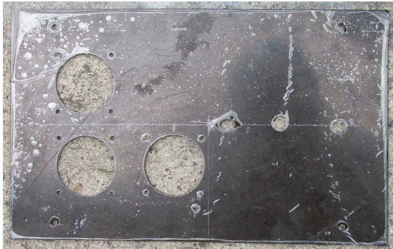
Figura 4.17 Perforación de la placa de acrílico para el panel de instrumentos.
