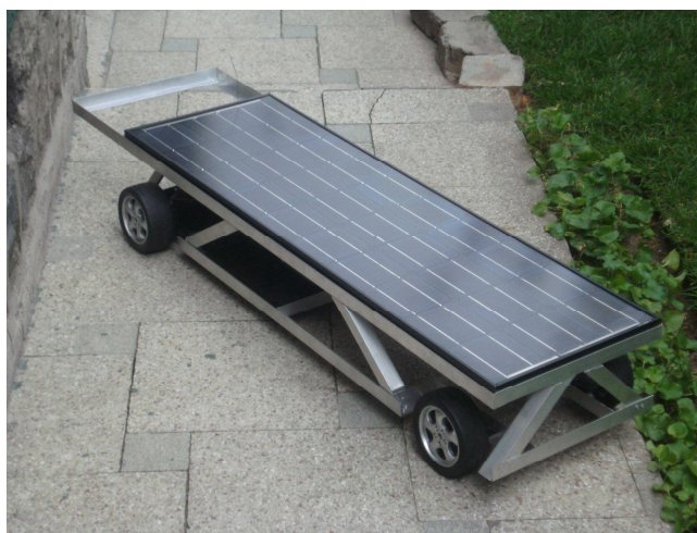
Figura 4.14 Posición del panel fotovoltaico
