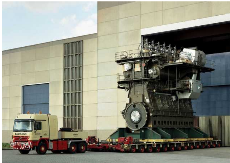
Figura 1.33 Vista de un motor marino. 36
