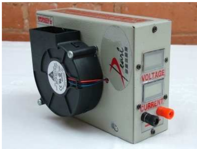
Figura 1.34 Pila de hidrógeno. (La celda es la estructura cúbica del centro de la imagen). 37
