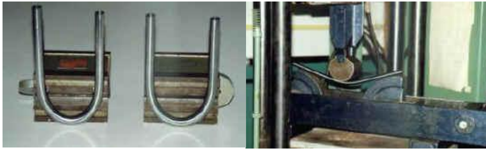
Figuras 1.16.- Ensayo de doblado.
