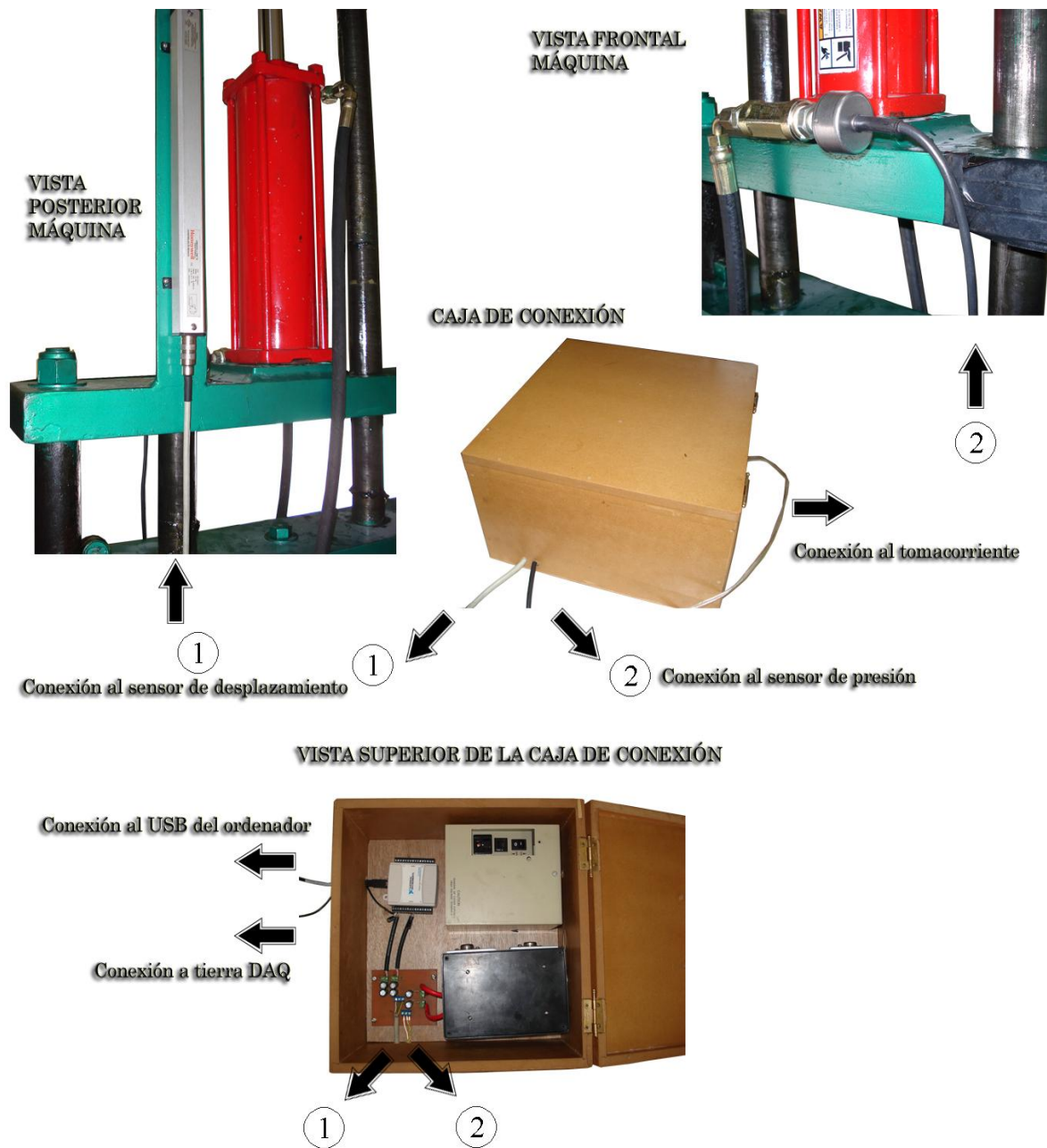
Figura 4.- Conexión de la caja.
