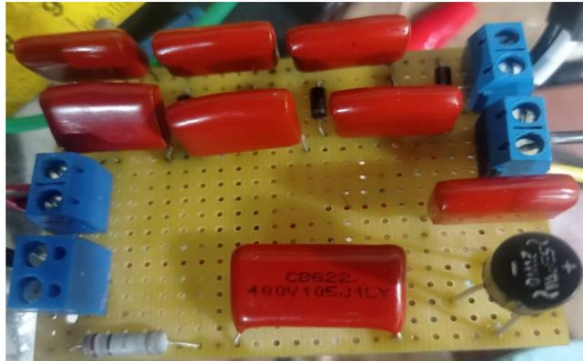
*Nota.* Etapas; multiplicadora, resonante y rectificadora del receptor del sistema.
