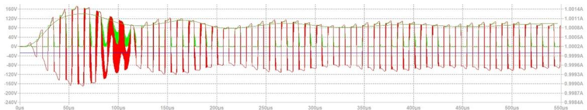
*Nota.* Voltaje en la bobina receptora (Rojo), voltaje de salida en la carga (Verde), amperaje de salida en la carga (Azul).
