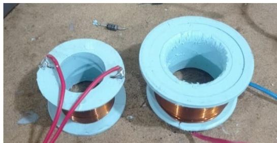
*Nota.* Bobina primaria y secundaria con núcleo de aire.
