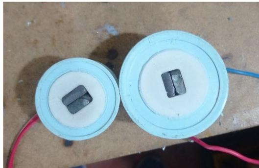
*Nota.* Bobina primaria y secundaria con núcleo de ferrita separada.
