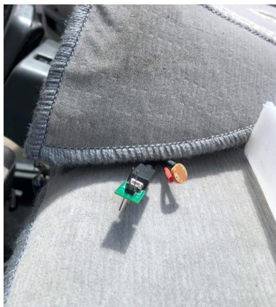
El módulo Arduino de efecto Hall para detectar las rpms, se colocó en la pared externa de la estructura donde van la banda de accesorios, ya que son las mismas revoluciones del motor.
