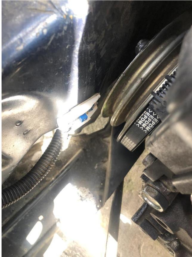
De igual manera se instaló el módulo de velocidad del vehículo en el eje que sale de la caja de cambio hacia la rueda, y detectar el giro de esta.
