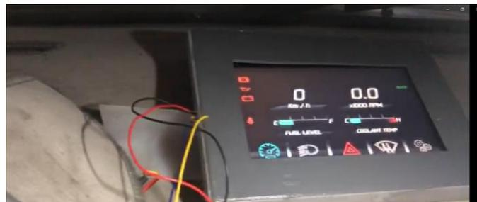
Para la segunda condición en sensor de luz detecta poca luz y está en el rango indicado, enciende las luces de posicion y cruce, en esta ocasión se apagó la linterna que se tenía para la prueba el sensor LDR, consigue el valor para después cumplir las condiciones del código de programación como se observa a continuación en la imagen
