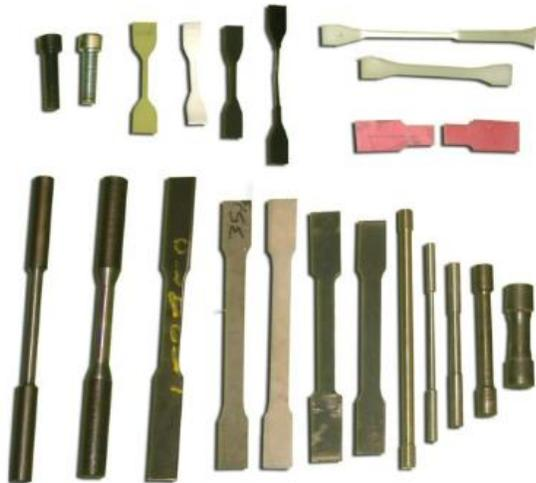
*Nota.* La figura indica los diferentes tipos de probetas que se utilizan para realizar ensayos destructivos del material. Tomado de (solutions, 2023)
