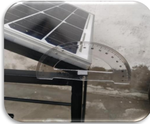
Ajuste del panel a un ángulo de inclinación de 23.45^\circ grados en con relación a la línea ecuatorial
