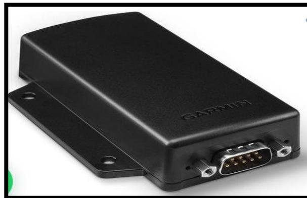
Fuera de componentes electrónicos para minimizar cualquier interferencia magnética externa
