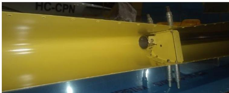
Para el remachado de las pieles TOP y BOTTOM SKIN colocamos las pieles en una mesa de acero para posteriormente aplicar la técnica de remachados BACK RIVERING sin antes colocar remaches AN426AD3-3 para luego sujetarlos con una cinta 3M de remachado especial mostrada en la sección 5F en la que describe el método de remachado del manual de estructura de la aeronave uniendo así a las pieles las correspondientes partes aplicando este mismo procedimiento para armar el alerón derecho.
