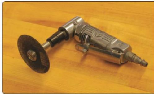
*Nota.* La imagen nos muestra un Die Grinder o cortador neumático de 90° sirven para hacer cortes en láminas de aluminio etc. Tomado de (Federal Aviation Federal Aviation, 2018, pág. 175).
