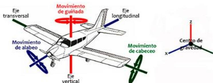
*Nota.* La siguiente imagen muestra los movimientos y fuerzas que actúan en una Aeronave en los planos X, Y, Z. Tomada de ( ZKREATIONS & BLOGGER, 2021).
