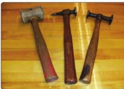
*Nota.* En la imagen muestra los tipos de mazo utilizados en aviación hechos de cuero, acero, caucho. Tomado de (Federal Aviation Federal Aviation, 2018, pág. 194).
