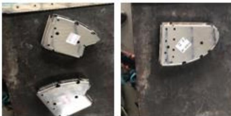
Finalmente taladre con una broca #30 equivalente a (3.3mm o 0,129in) de diámetro los huecos de las costillas A-1006-1A Outboard Hinge Brackets, A1004-1R Y A-1004-1L Nose Rib. Realice countersink en el Outboard Hinge Brackets A-1006-1A el countersink debe ser justo al diámetro de la cabeza del remache AN426AD4 hasta quedar a ras de piel, limpie los orificios y los bordes de los Brackets y las costillas de nariz A-1004-1R y A-1004-1L.
