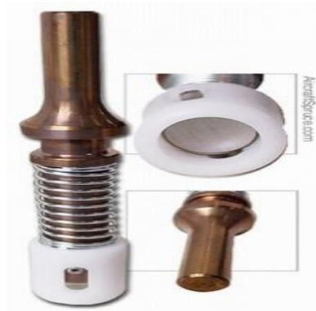
Nota. Estas herramientas también se utilizan para "remachar hacia atrás" (Back Riveting) el vástago del remache cuando la superficie de la cabeza del remache es inaccesible, la presión del resorte mantiene el remache firmemente contra la superficie de la piel cuando se remacha al ras. Tomado de (Aircraft Spruce & Specialty Co., 1995-2023).
