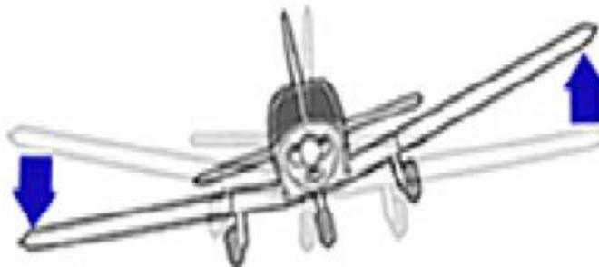
*Nota.* Esta imagen muestra el eje longitudinal en el eje de las X conocido como Alabeo.
