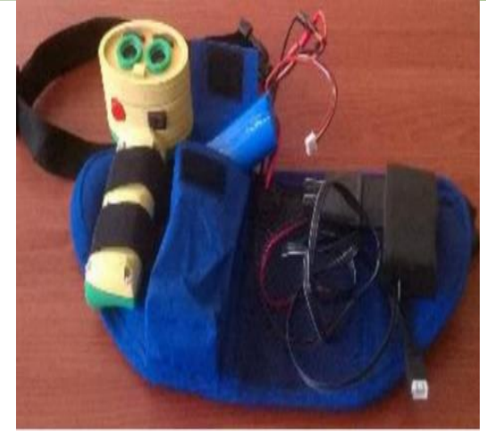
C) Prototipo con detección de obstáculos Cristina Loayza (2016)
