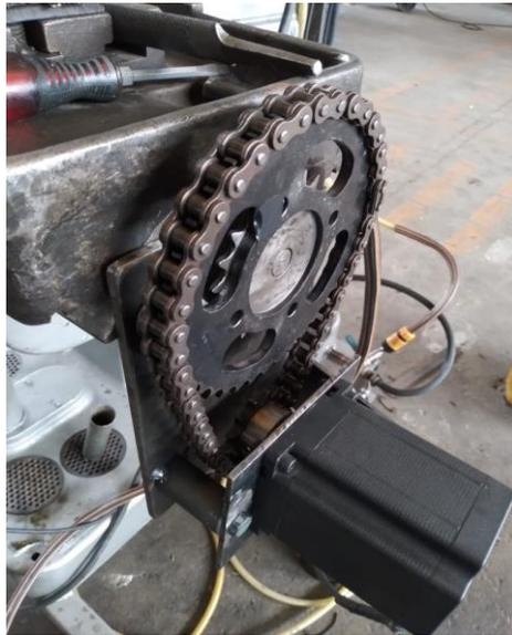
La corriente de trabajo en el posicionamiento rápido presenta picos que ocasionan el sobrecalentamiento del motor
