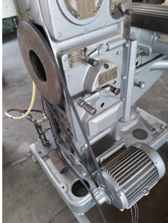
Reducción mediante poleas 9:35 al sistema de transmisión del motor trifásico y la caja de engranajes de la máquina.
