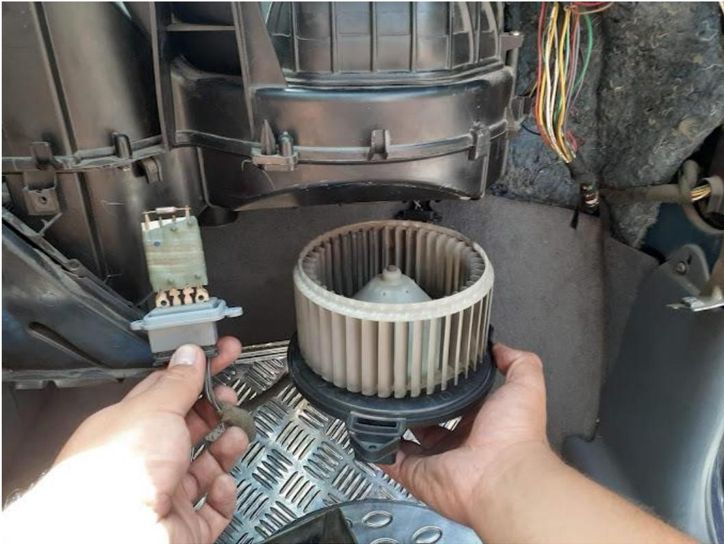
Ajuste del soplador entre los ductos del sistema de calefacción y filtro de polen
