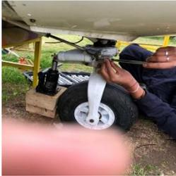
Asegúrese de que los espaciadores y las bridas de la rueda estén asentados en la brida del cubo de la rueda. Un par de apriete desigual o inadecuado de los tornillos de cabeza puede provocar el fallo de los tornillos de cabeza o de las roscas del buje, con el consiguiente fallo de la rueda.
