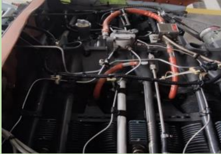
Inspección de las líneas de combustible del moto
