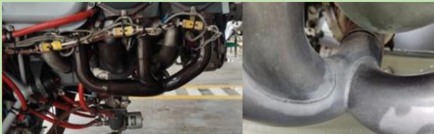
Sistema de escape del motor
