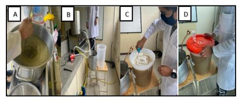
Nota. A) Whirlpool, B) Sistema de enfriado, C) Colocación de la levadura, D) Cerrado y colocación de airlock.
