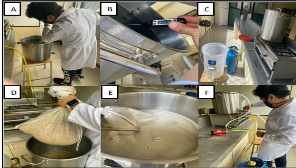
A) Colocación del agua, B) Medición de temperatura, C) Extracción de 10 litros de agua D) Colocación de malla para maceración, E) Remojo del grano, F) Recirculado
