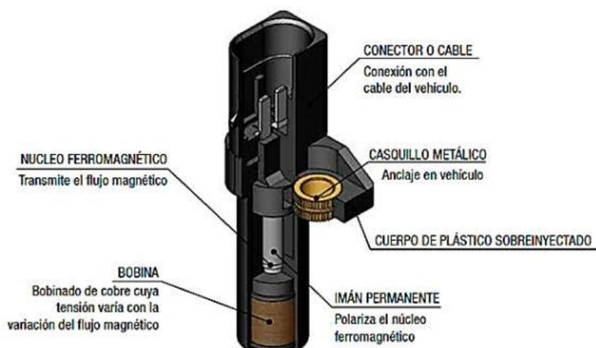
*Nota.* El gráfico muestra un esquema del sensor RPM y sus componentes. Tomado de *Manuales de computadoras y módulos automotrices*, por Orozco, M., 2020, Toyota Hiace.
