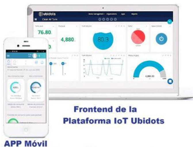
*Nota.* La figura representa un *Dashboard* creado en Ubidots y una aplicación móvil que permite la gestión y visualización de los datos.
