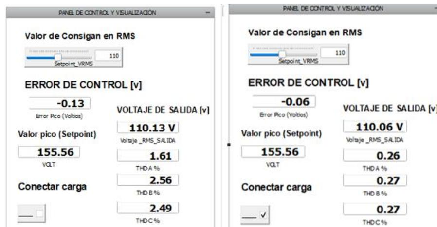
*Nota.* En la Figura 76 se evidencia el valor de la THD para el inversor NPC 3L. En la parte izquierda de la Figura 76 en la parte izquierda se muestra el valor de THD en % para las fases A, B, C del inversor en vacío ( $1000 \Omega$ ) y en la parte derecha se muestra el valor de THD en % para las fases A, B, C del inversor con carga RL de  $5 \Omega - 0.6 \text{ mH}$ .
