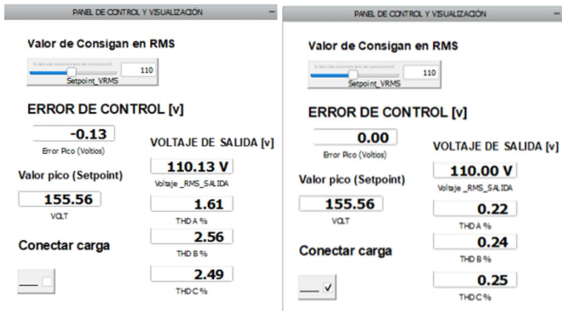
*Nota.* En la Figura 74 se evidencia el valor de la THD para el inversor NPC 3L. En la parte izquierda de la figura 44 en la parte izquierda se muestra el valor de THD en % para las fases A, B, C del inversor en vacío (1000  $\Omega$ ) y en la parte derecha se muestra el valor de THD en % para las fases A, B, C del inversor con carga de 5  $\Omega$ .
