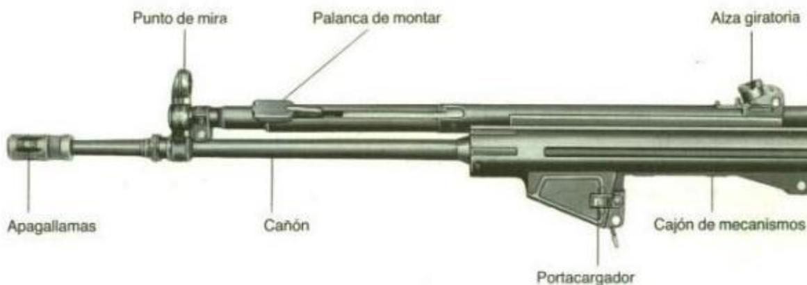
*Nota.* Estructurado el tubo cañón con sus respectivos dispositivos de montar y puntería.
