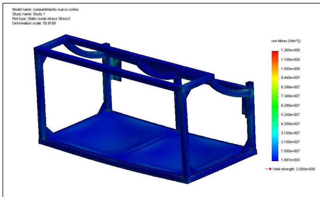
Figura 3.22: Distribución de Esfuerzos Compartimiento Lateral (a).
