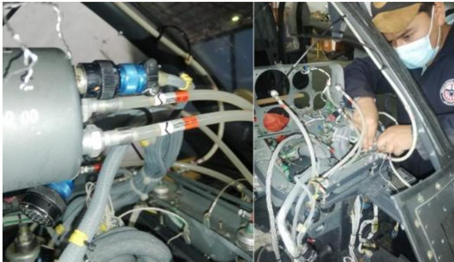
*Nota.* Las conexiones de los instrumentos, cañerías y uniones deben tener el apriete adecuado.
