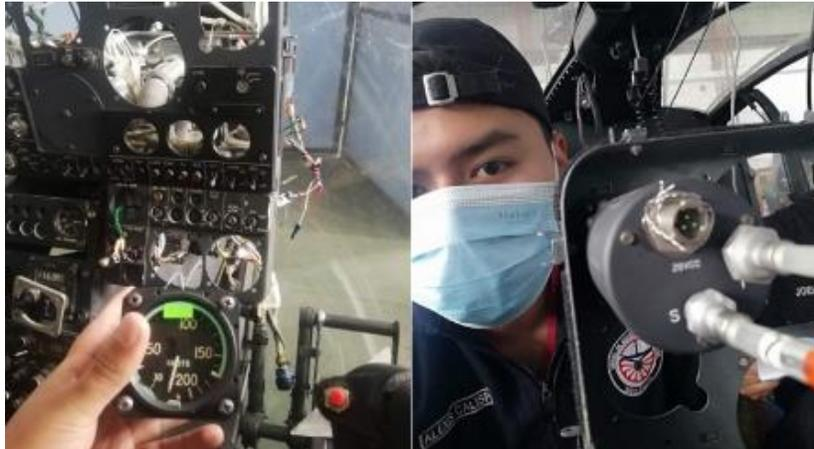
*Nota.* Instalación del indicador de velocidad, tuberías conectadas, apretadas y bloqueadas.
