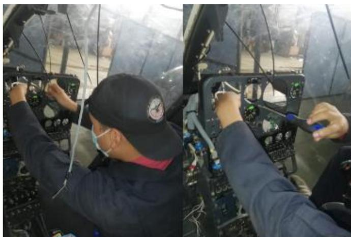
*Nota.* Instalación del altímetro, tuberías conectadas, apretadas y bloqueadas.
