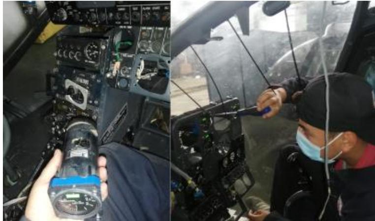
*Nota.* Instalación del indicador de velocidad vertical, tuberías conectadas y bloqueadas.
