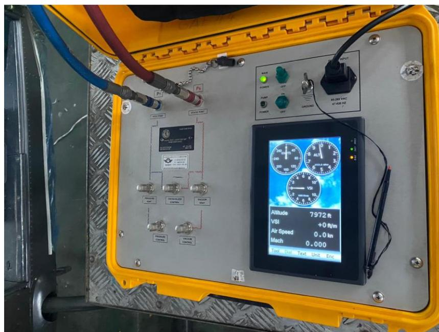
*Nota.* Banco de pruebas DPST-8000M Air Data Test Set necesario para el chequeo de fugas.
