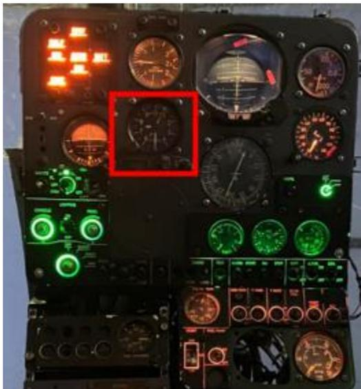
*Nota.* Altímetro instalado en el panel de instrumentos.
