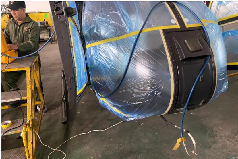
*Nota.* Chequeo de fugas del sistema pitot-estático con el banco de pruebas DPST-8000M.
