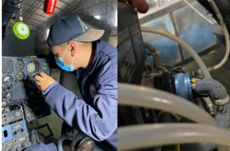
*Nota.* Instalación del horizonte artificial, conexiones apretadas y bloqueadas.
