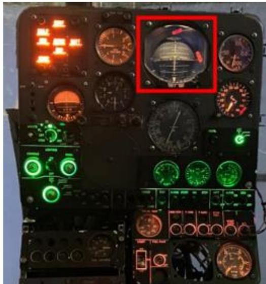
*Nota.* Horizonte artificial instalado en el panel de instrumentos.
