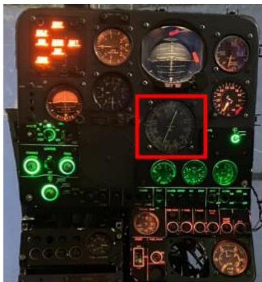
*Nota.* Unidad giroscópica instalada en el panel de instrumentos.
