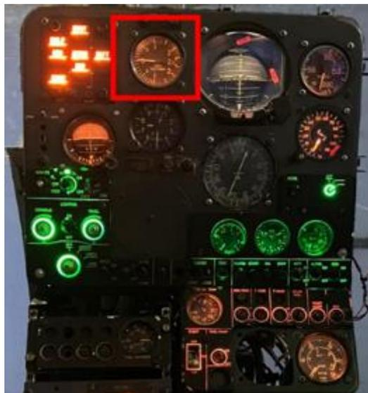
*Nota.* Indicador de velocidad vertical instalado en el panel de instrumentos.
