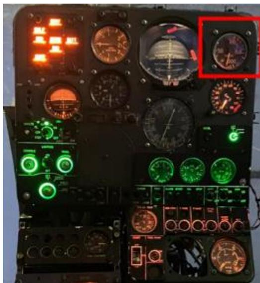
*Nota.* Indicador de velocidad instalado en el panel de instrumentos.
