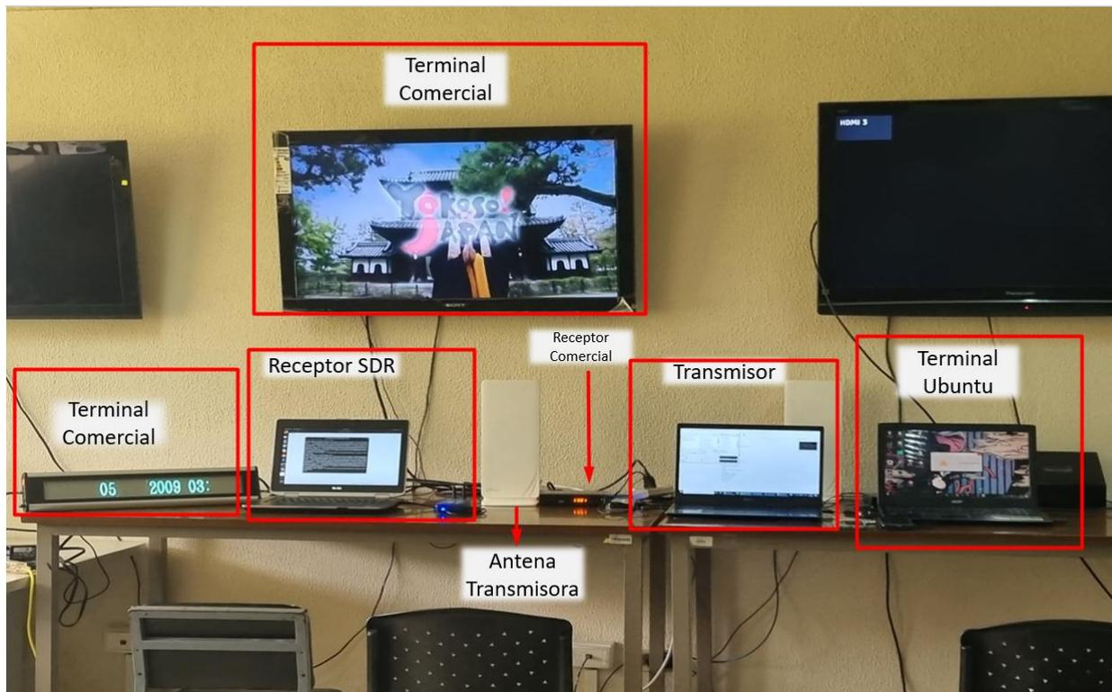
*Nota.* La figura muestra los elementos que conforman el Sistema de Televisión Digital del laboratorio de la Universidad de las Fuerzas Armadas – ESPE, en color rojo están sus respectivos identificadores.
