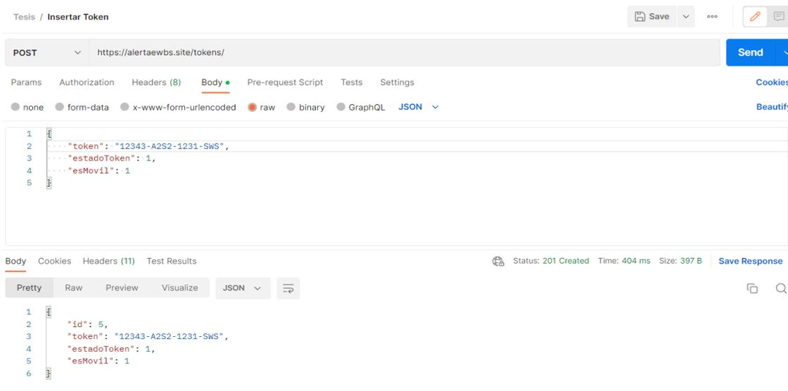
*Nota.* La figura muestra una petición POST mediante el software Postman para guardar o registrar un nuevo cliente del Gateway Server.
