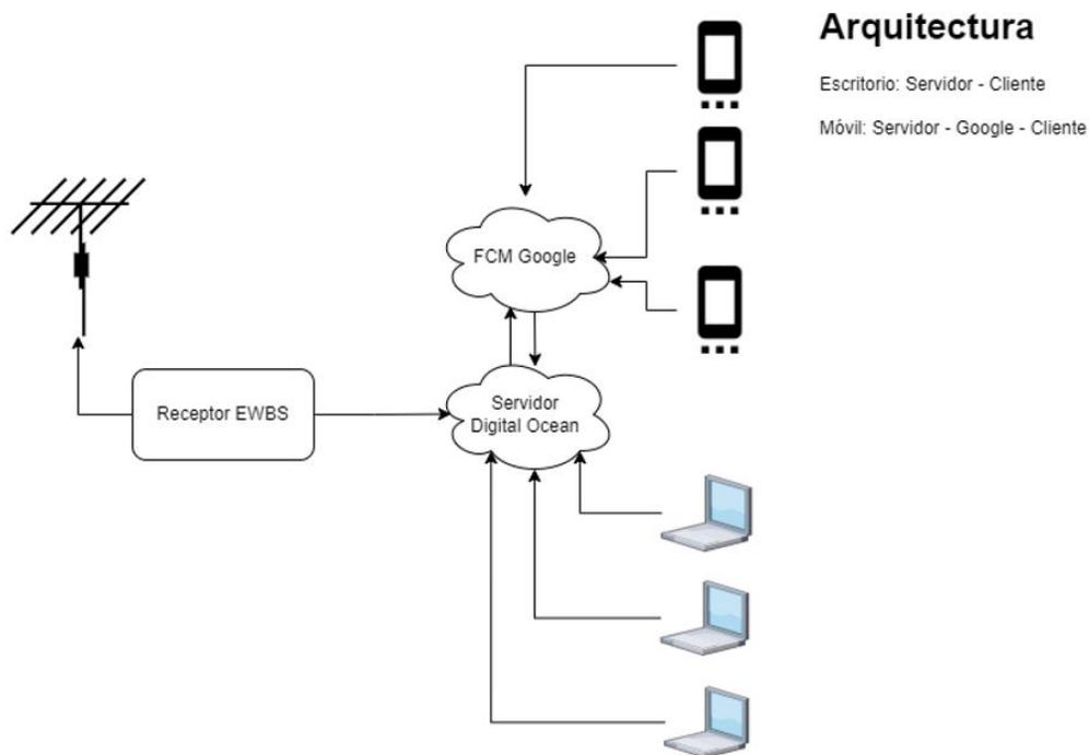
*Nota.* La figura muestra un Gateway Server implementado en el laboratorio de televisión digital de la Universidad de las Fuerzas Armadas – ESPE utilizando cómputo en la nube.
