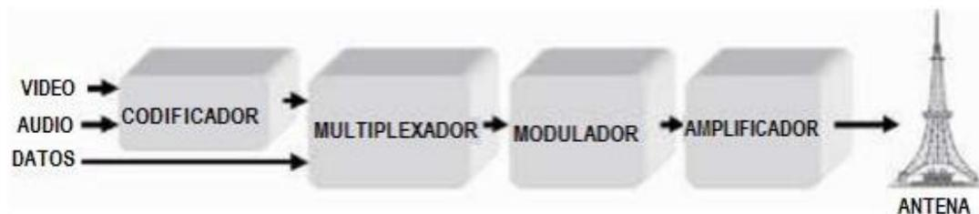
*Nota.* La figura muestra el diagrama de bloques de un Sistema de transmisión ISDB-Tb. Tomado de *Análisis del Transport Stream para el estándar de televisión digital ISDB-TB* (p. 29), por Granja y Olmedo, 2011.
