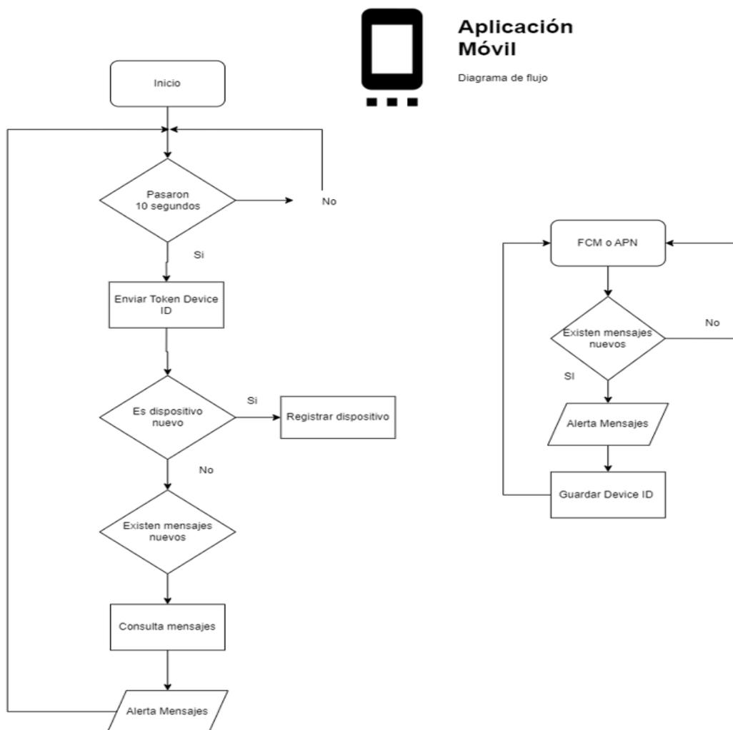
*Nota.* La figura muestra el diagrama de bloques del funcionamiento de la aplicación móvil desde el registro y la recepción de mensajes.
