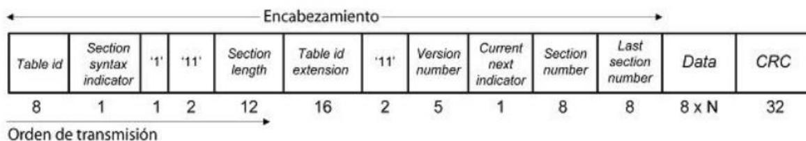
*Nota.* El gráfico muestra la estructura de una sección de un flujo de transporte TS. Tomado de *Análisis del Transport Stream para el estándar de televisión digital ISDB-TB* (p. 82), por Granja y Olmedo, 2011.
