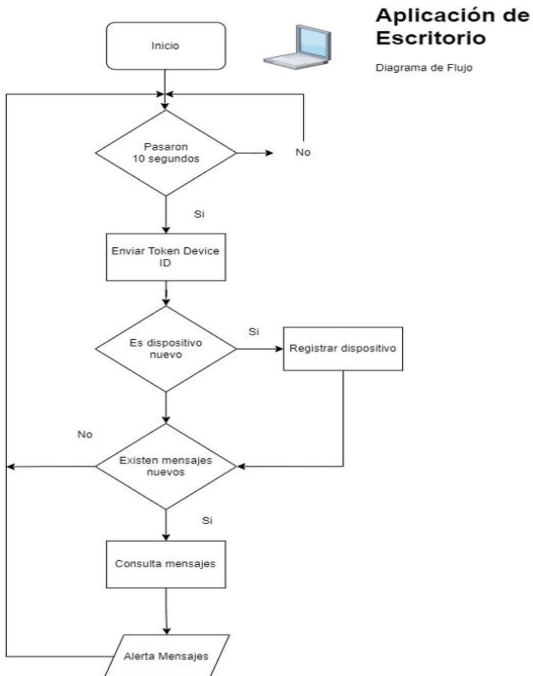
*Nota.* La figura muestra el diagrama de bloques del flujo de funcionamiento de la aplicación de escritorio desde su registro hasta la recepción del mensaje.
