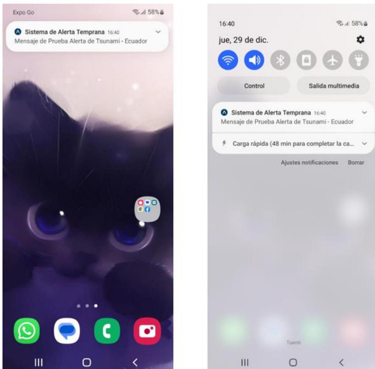
*Nota.* La figura muestra el funcionamiento de la recepción de mensajes de alerta temprana en ambiente Android.
