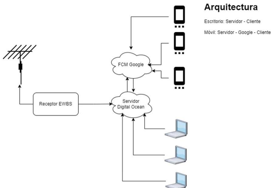
*Nota.* La figura muestra el diagrama de bloque del Gateway Server implementado.
