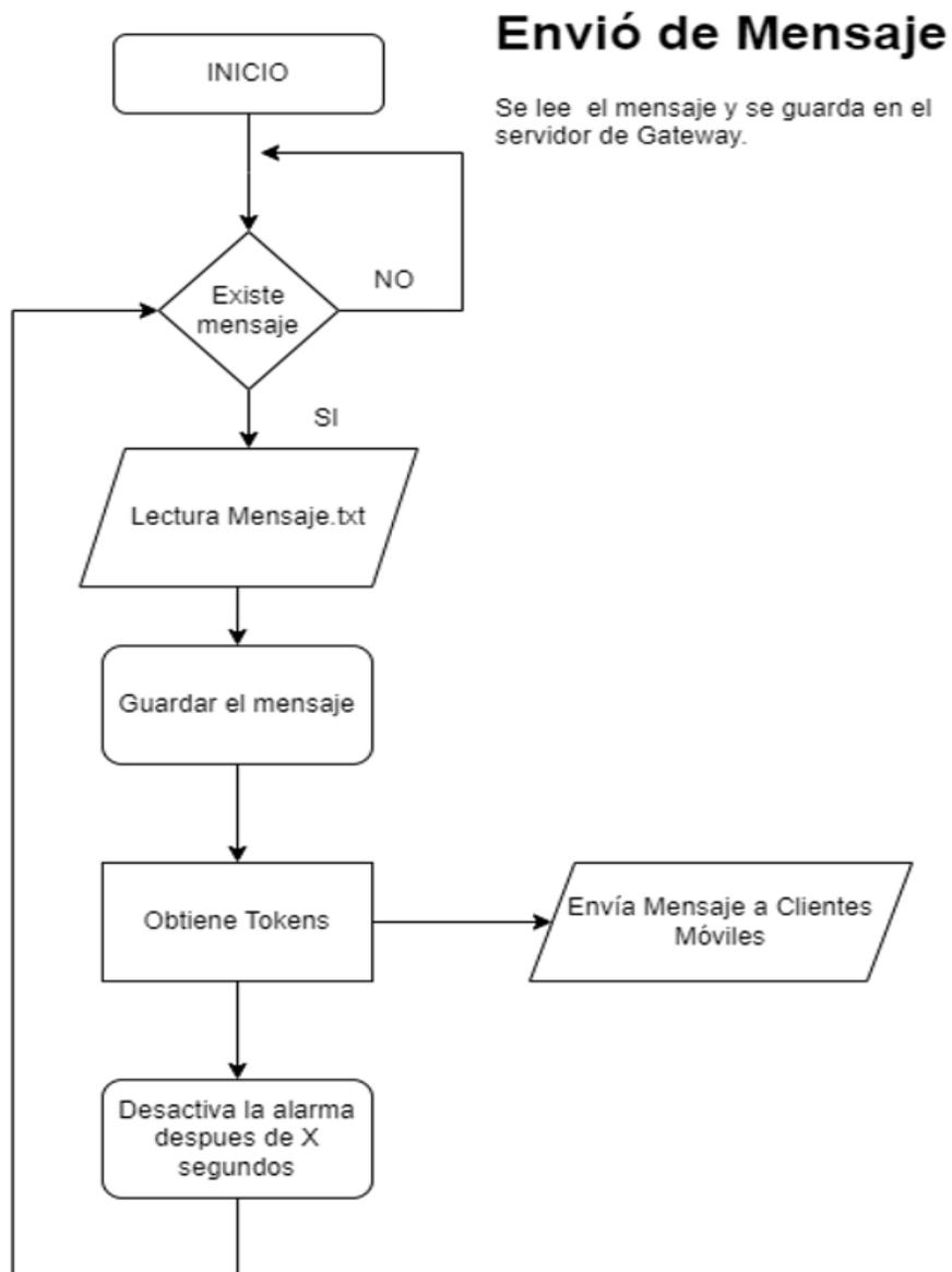
*Nota.* La figura muestra el diagrama de bloques de la lectura del mensaje decodificado, para luego enviar a los diferentes dispositivos.
