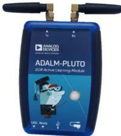
*Nota.* La figura muestra un SDR Adlam Pluto. Tomado de *Adalm – Pluto SDR Active Learning Module* (p. 2), por Analog Devices, 2017.
