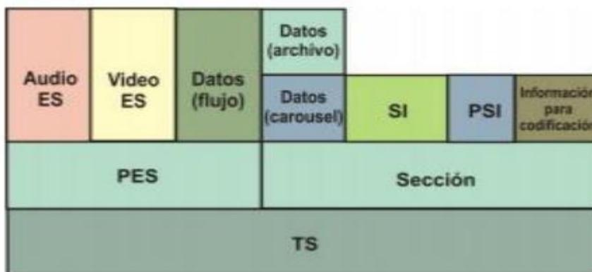
*Nota.* La figura muestra la estructura de un flujo de transporte. Tomado de *Análisis del Transport Stream para el estándar de televisión digital ISDB-TB* (p. 95), por Granja y Olmedo, 2011.
