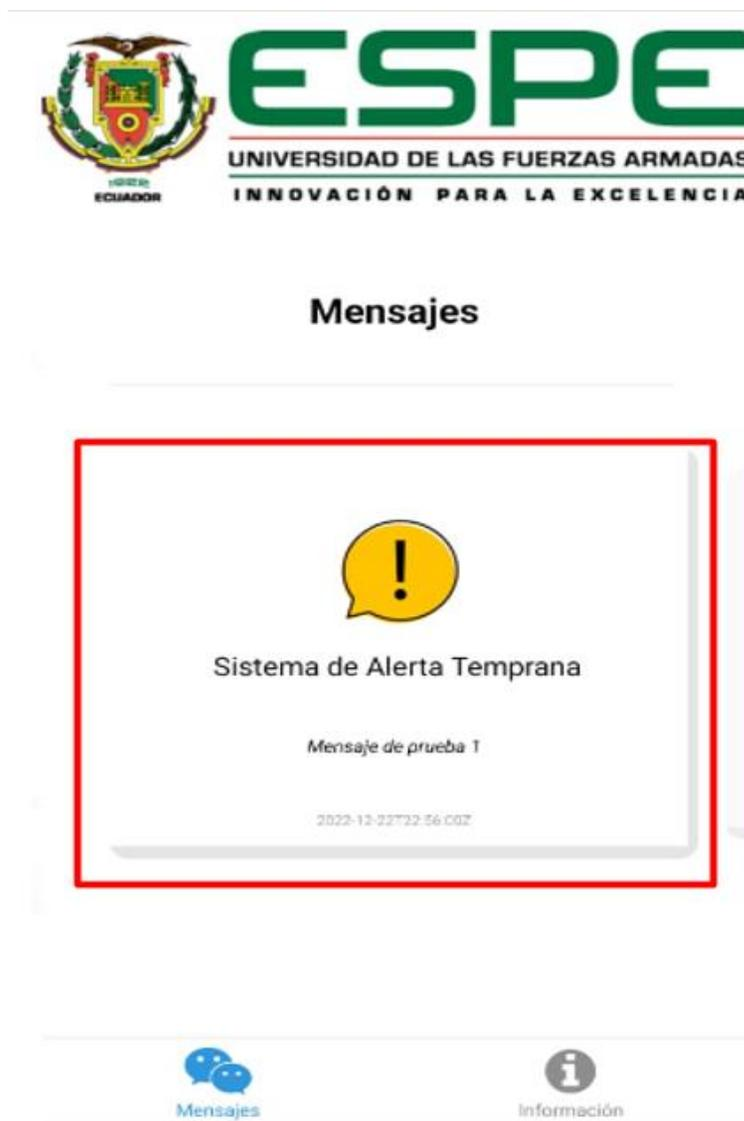
*Nota.* La figura muestra la interfaz de la aplicación móvil, en el recuadro rojo se muestra el componente carrusel que se renderiza cuando llega un nuevo mensaje.
