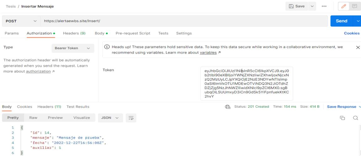
*Nota.* La figura muestra la configuración necesaria para enviar petición a un servidor con autenticación en este caso la autorización es de tipo Bearer.
