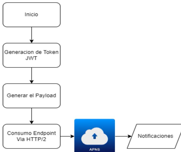
*Nota.* La figura muestra el diagrama de bloques del proceso de enviar notificaciones a un terminal iOS.
