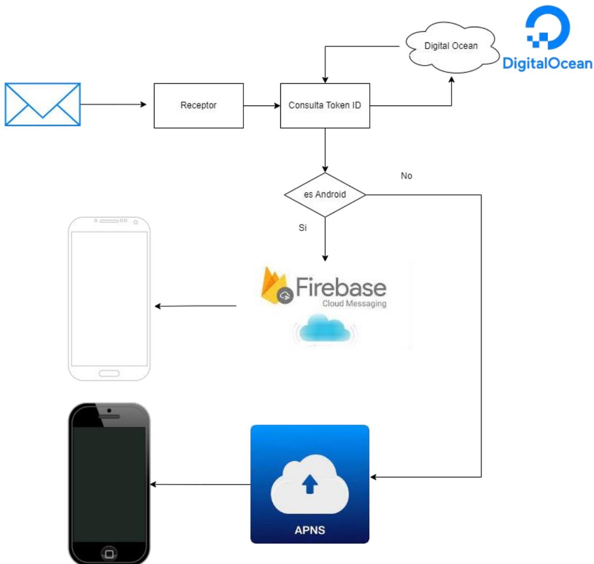
*Nota.* La figura muestra un diagrama de bloques del funcionamiento del envío de mensajes de alerta temprana mediante APNs o FCM.
