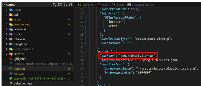
*Nota.* La figura muestra la estructura de un proyecto en React Native con expo-cli y además el archivo de configuración app.json de donde se obtiene el package identificador de la aplicación para Google.
