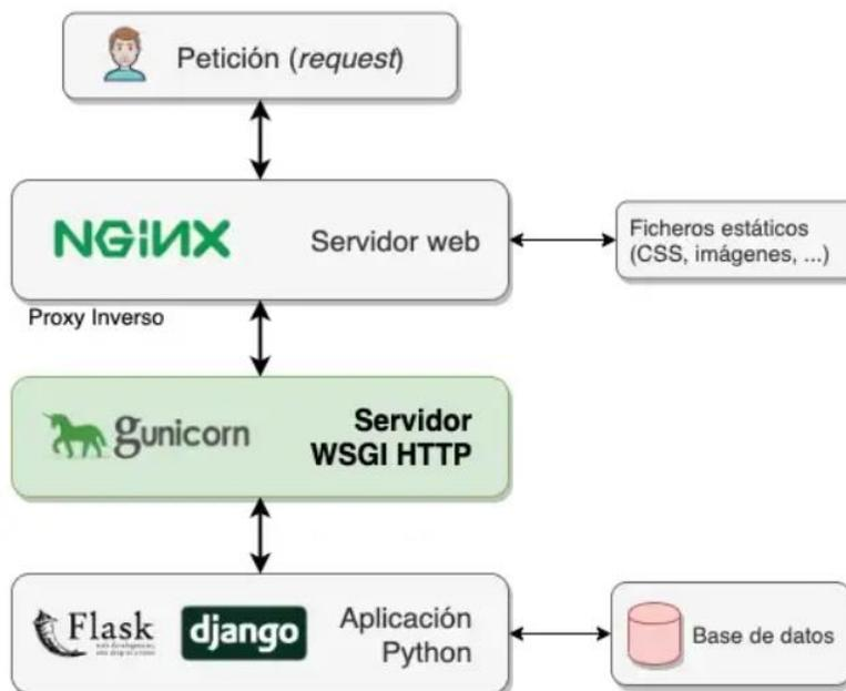
*Nota.* La figura muestra el diagrama de bloques del funcionamiento de Nginx como servidor web de python con Django. Tomado de *¿Qué es un WSGI?*, por Ignacio Alonso, 2019.
