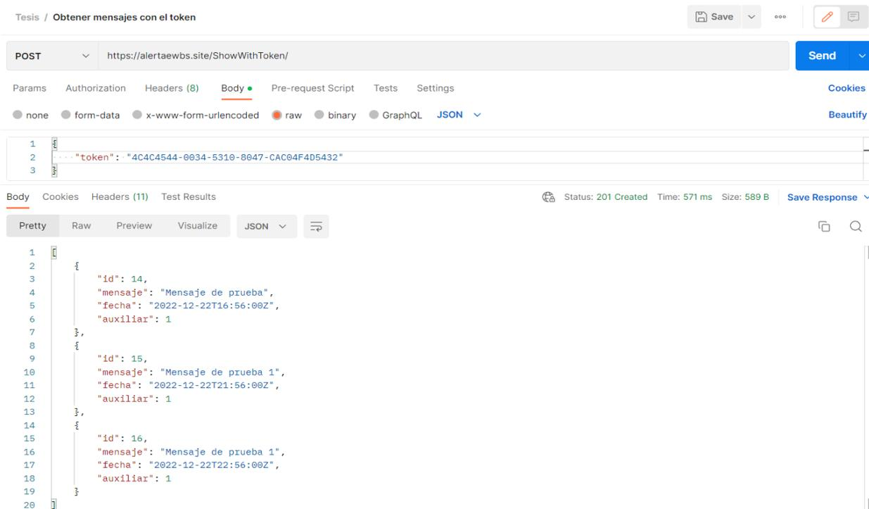
*Nota.* La figura muestra una petición POST mediante el software Postman para obtener una lista de mensajes no leídos de un cliente en específico enviando su token id.
