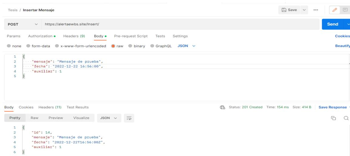
*Nota.* La figura muestra un ejemplo de petición POST mediante el software Postman para insertar un mensaje, además se muestra el payload necesario.
