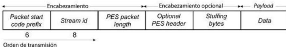
*Nota.* La figura muestra la estructura dentro de un paquete PES utilizado en el flujo de transporte TS. Tomado de *Análisis del Transport Stream para el estándar de televisión digital ISDB-TB* (p. 84), por Granja y Olmedo, 2011.
