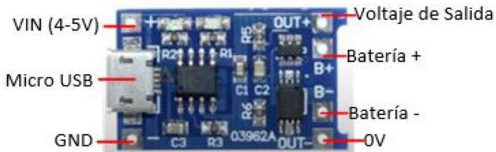
El módulo TP4056 posee una resistencia programable R3 que nos permite una corriente de carga de hasta 1A para la batería, como se muestra en la Tabla 10 obtenida de la hoja de especificaciones del módulo. Por defecto la corriente de carga de la resistencia programada del módulo es de 1A.
