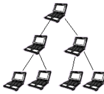
Figura 1.4 Estructura de la topología árbol
