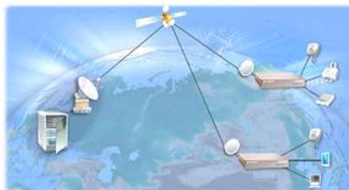
Figura 1.36 Recepción de Internet en PC's vía Satélites
