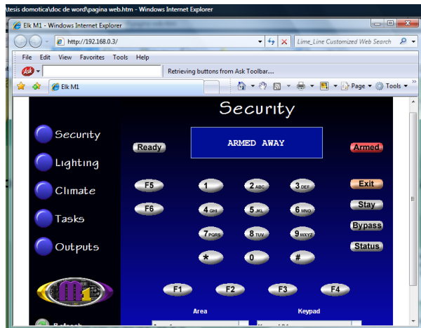
Figura 4.21 Activación del sistema vía Internet
