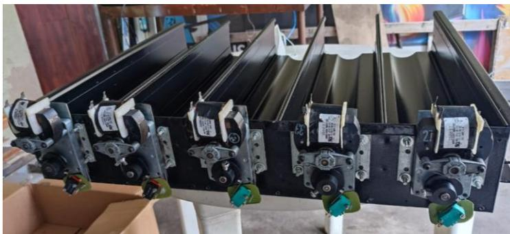
Con respecto al cableado, cada motor a pasos junto con su respectivo driver L298N requieren de alimentación de 12V DC y 6 cables para su control (sin contar la conexión del driver al motor). Para la alimentación se emplea cable AWG 2x18 con terminales tipo puntera y para las señales de control se emplea cable de red UTP CAT5e con un conector molex de 6 pines para cada driver. El cableado descrito para los motores a pasos se muestra en la figura 102.
