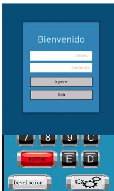
**Pantalla de configuración.** La pantalla de configuración permite seleccionar si se va a realizar una configuración en los precios o en el inventario interno de la máquina puesto que si los productos cambian es necesario modificar los precios y si la máquina se rellena es necesario modificar el inventario interno para poder generar las notificaciones de productos escasos vía correo electrónico. El diseño de esta pantalla se muestra en la figura 94.
