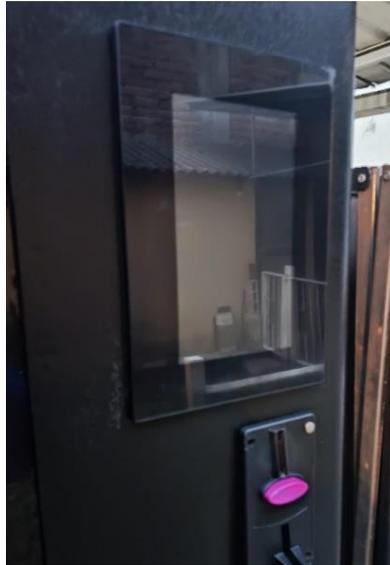
La pantalla requiere de alimentación a 5V DC y dos cables para la comunicación con el controlador, para la alimentación se emplea cable AWG 2x18 y para la transmisión de información con el controlador se emplea cable de red UTP CAT5e. El montaje y conexión de la pantalla se muestra en la figura 114.
