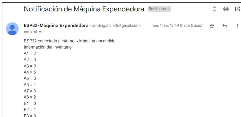
Siempre que exista una red, la tarjeta microSD esté conectada y las credenciales de red sean correcta, el módulo ESP32 debe poder conectarse a internet y enviar la notificación mostrada cada que la máquina se encienda. Para verificar la conexión a internet se realizan 20 pruebas considerando que la tarjeta microSD está conectada, las credenciales de red son correctas y el módem se encuentra a 15 metros de distancia de la máquina, obteniendo así los siguientes resultados mostrados en la tabla 54.
