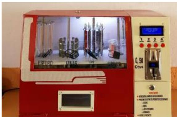
*Nota.* Tomado de *Diseño y construcción de máquina dispensadora automática de materiales de escritorio mediante el uso de la plataforma Arduino* (p. 108), por Arévalo Chalacán & Bolaños Gaona, 2018, [Tesis de pregrado, Universidad Politécnica Salesiana].
