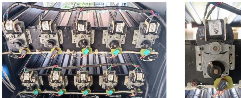
El paso del cableado dentro de la máquina se lo realiza por la pared derecha para los cables de potencia y por la pared izquierda para los cables de control como se muestra en la figura 104. Para que estos cables no queden sueltos se sujetan con amarras plásticas y bases adhesivas pegadas a las paredes de la máquina. Por otro lado, es importante dejar una longitud de cable adecuada para que cada bandeja pueda salir por la puerta frontal sin que exista alguna desconexión de los elementos.
