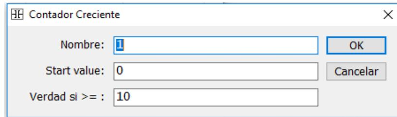
En el diagrama LDR del ejemplo del contador incremental, la entrada X1 es por donde ingresen los pulsos, cuando el contador sea mayor o igual a 10 activa a la salida Y1. X2 sirve para reiniciar el contador.
