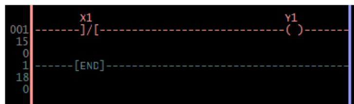
Al accionar el pulsador el contacto NC, X1, del diagrama Ladder se abre, interrumpe la corriente de la bobina y desactiva la salida Y1.
