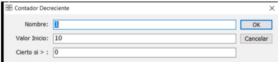
Una vez cargado el valor C1=10, el relé interno R1 está activado. Asociado a la salida Y1 está incluido una condición si el valor de conteo de C1==0. Al recibir los pulsos el contador decrementa el conteo a partir de 10 y al llegar a 0, cumple la condición C1==0, activando la salida Y1. Con un pulso en X2, el contador se restablece a 0.
