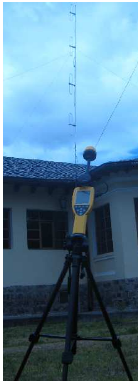
Figura 3.32. Medición del patrón de radiación del arreglo de dipolos doblados
