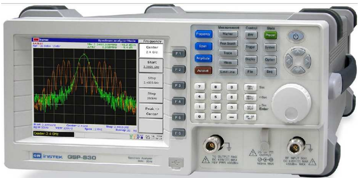
Figura 4.2. Analizador de Espectros GW-INSTEK GSP-830 18
