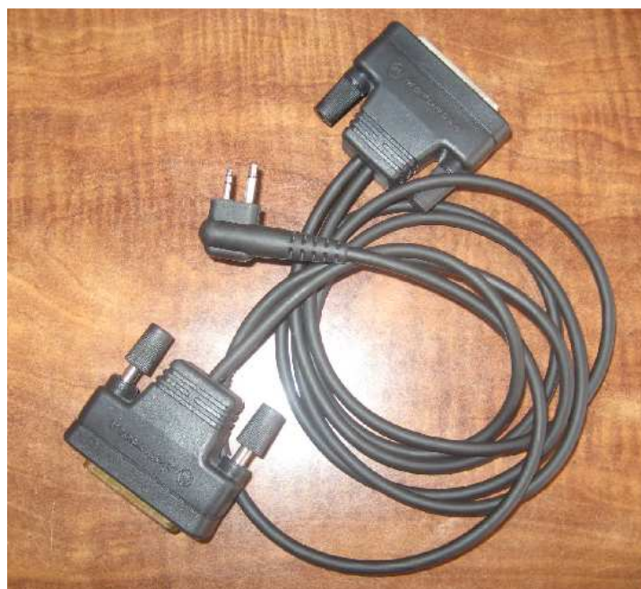
Figura 3.45. Cable de programación para radios Motorola PRO 3150
