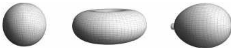
Figura 1.5. (De izquierda a derecha): Patrones de radiación para una antena isotrópica, para una antena omnidireccional y para una antena direccional 5
