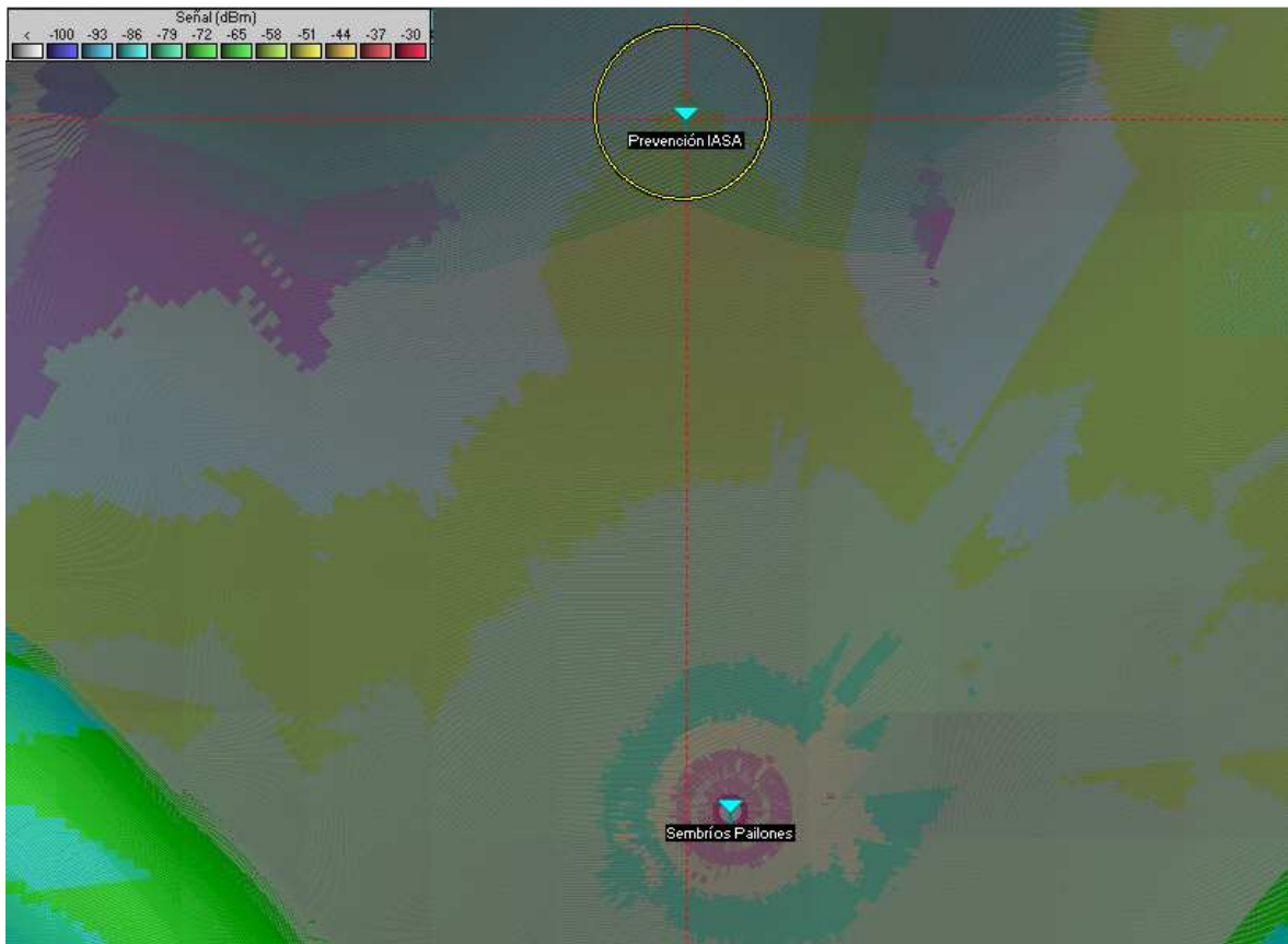
Figura 3.40. Simulación uplink sistema interno de radiocomunicaciones del IASA (El Prado)
