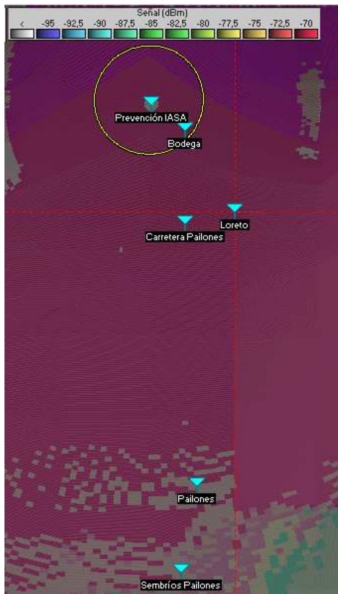
Figura 3.38. Simulación del mapa cobertura del arreglo de 4 dipolos doblados de la estación base en los lugares más alejados de las oficinas del IASA (El Prado)
