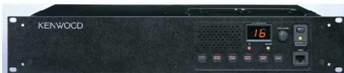
Figura 3.34. Estación Repetidora Kenwood TKR-750
